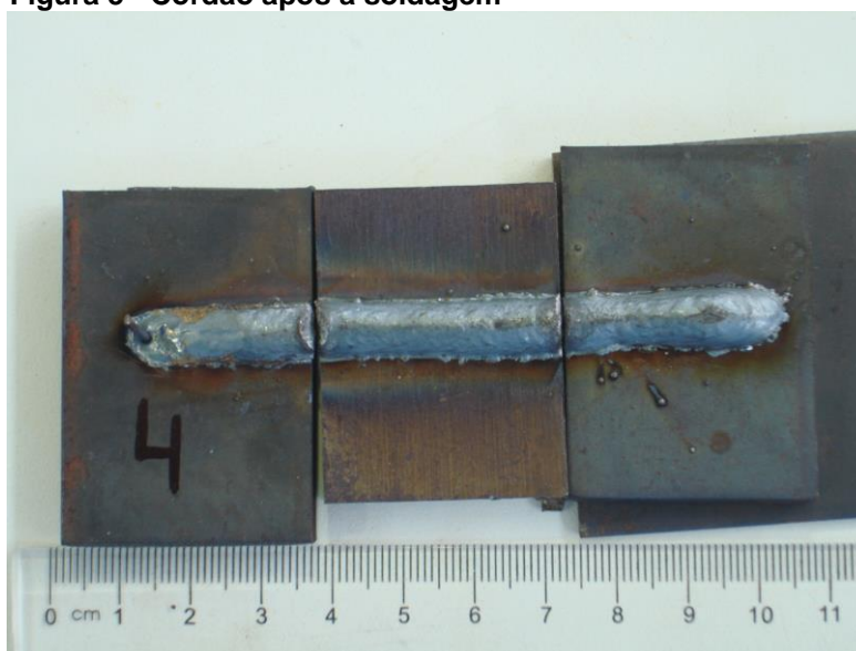
Figura 5 - Cordão após a soldagem
