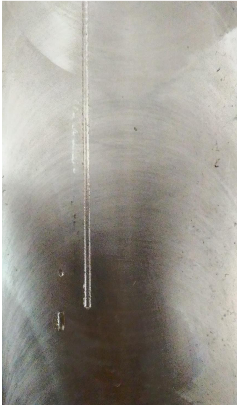
Figura 17 - Experimento utilizando microfresas de 0,7 mm de diâmetro
