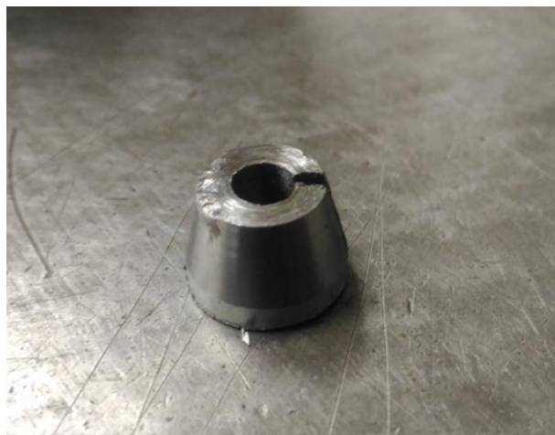
Figura 10 - Pinça fabricada para Tupia Skill 7800
