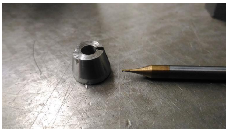
Figura 11 - Comparação da pinça com a microfresa de 0,7 mm de diâmetro
