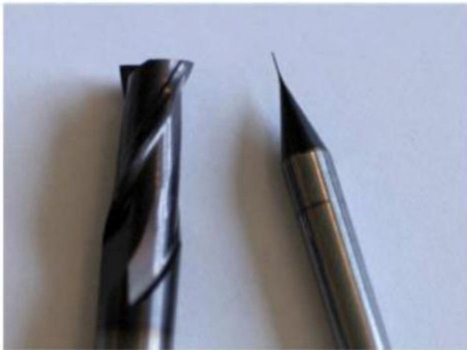
Figura 6 - Fresa de topo reto de 6 mm de diâmetro (à esquerda) e micro-fresa de 200 \mu\text{m} (à direita)
