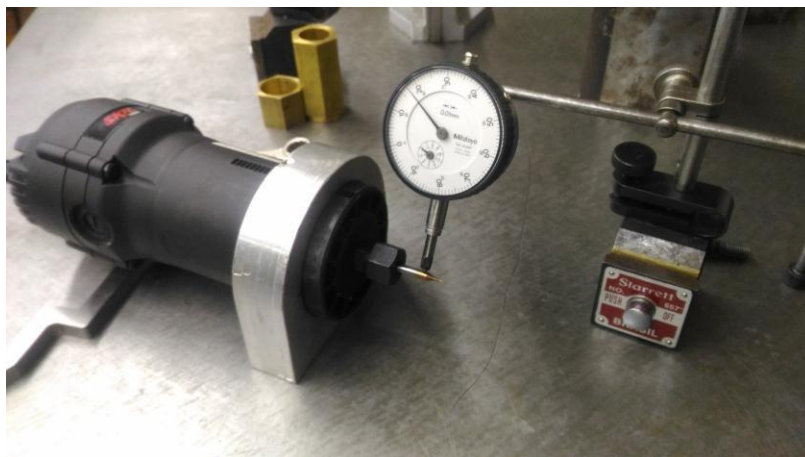
Figura 13 - Demonstração da medição realizada para confirmação do batimento devido a fabricação da pinça – valor negativo
