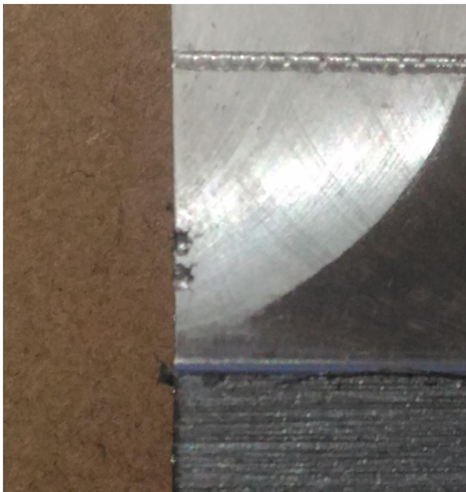
Figura 16 - Experimento utilizando microfresas de 0,4 mm de diâmetro.
