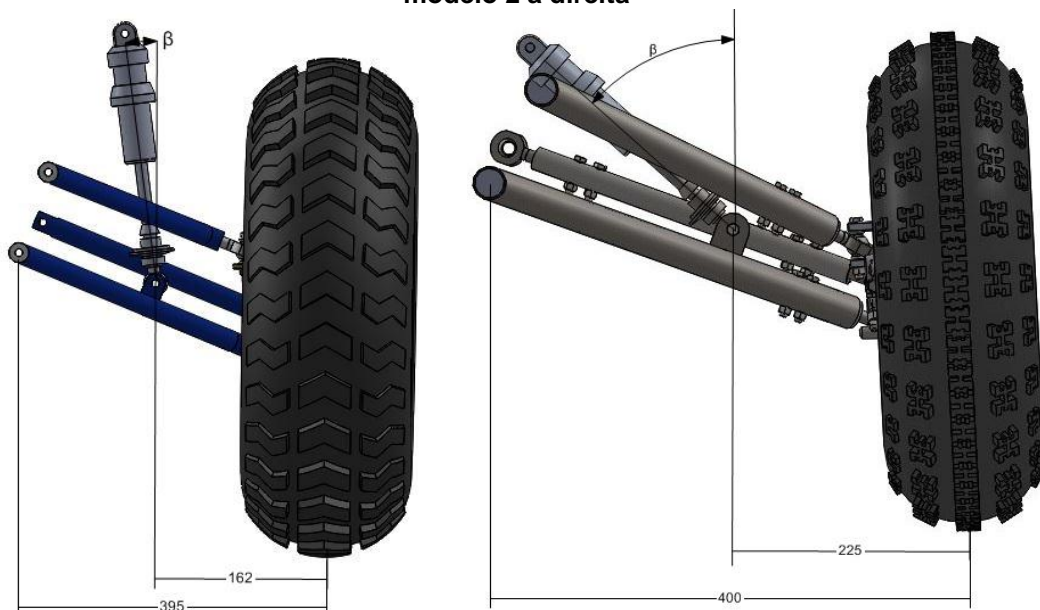
Figura 20 - Razão de instalação e inclinação do amortecedor para modelo 1 a esquerda e modelo 2 a direita
