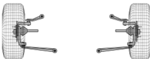
Figura 1: Mecanismo de suspensão tipo duplo A
