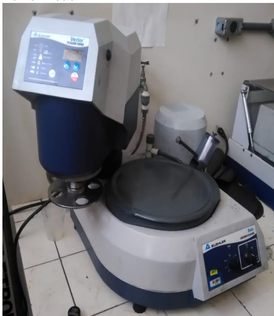
Figura 13: Politriz Buehler Beta Grinder com cabeçote Buehler Vector® Power Head.
