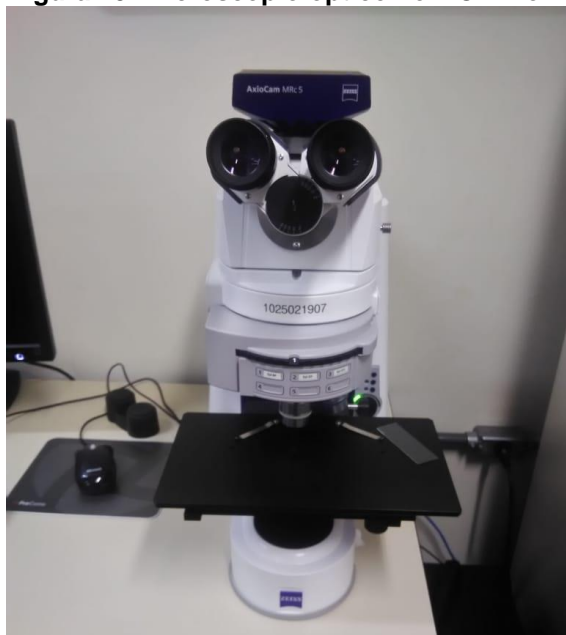
Figura 15: Microscópio ótico Lenz® Axio Imager A2m
