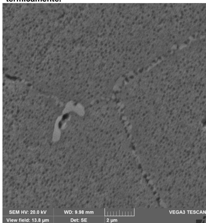
Figura 22: Detalhamento dos contornos de grão da amostra tratada termicamente.
