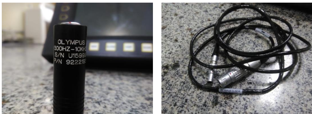
Figura 10: Sonda de superfície (a) e cabo (b) marca Olympus
