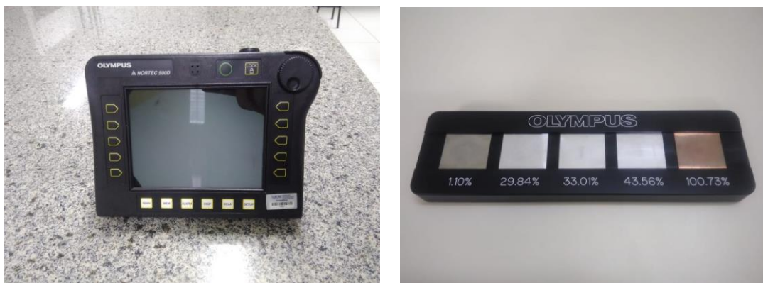
Figura 9: Olympus Nortec® 500D (a) e barra de calibração Olympus (b)
