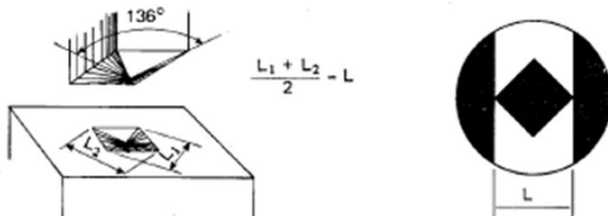
Figura 6 - Penetrador e impressão Vickers
