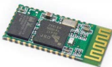
Figura 21 - Módulo Bluetooth HC-05 Fonte: Iteadstudio (2010)
