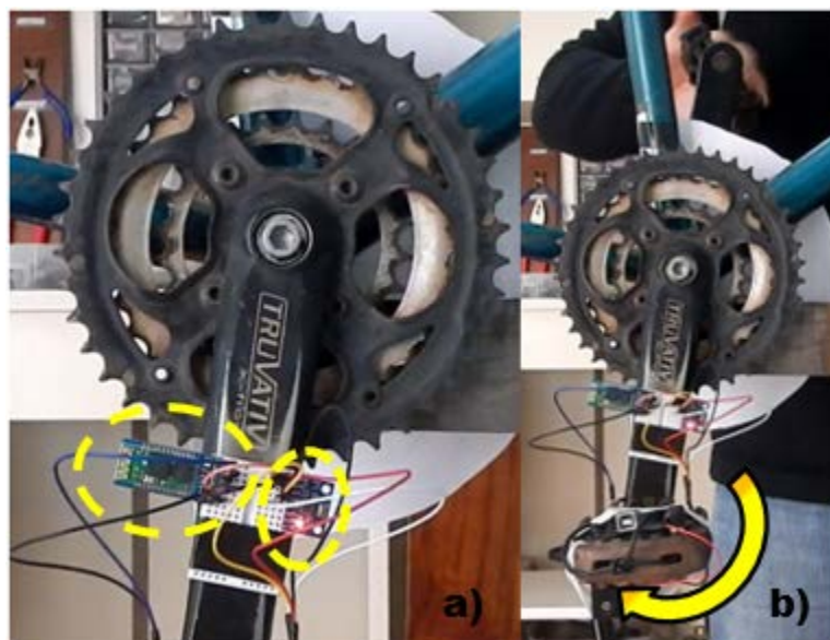
Figura 34 - a) instalação do módulo Bluetooth e do MPU-6050 na pedivela; b) Estrutura e sentido de rotação do teste Fonte: autoria própria
