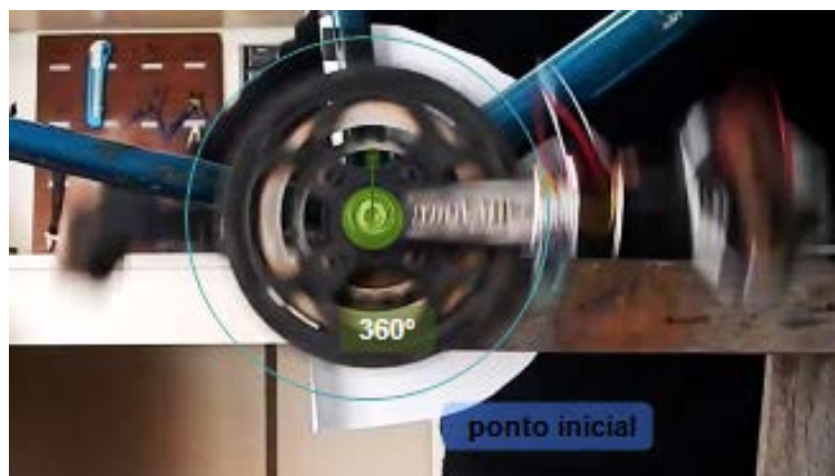
Figura 35 - Imagem retirada da filmagem de validação do sistema de medição de cadência do protótipo
