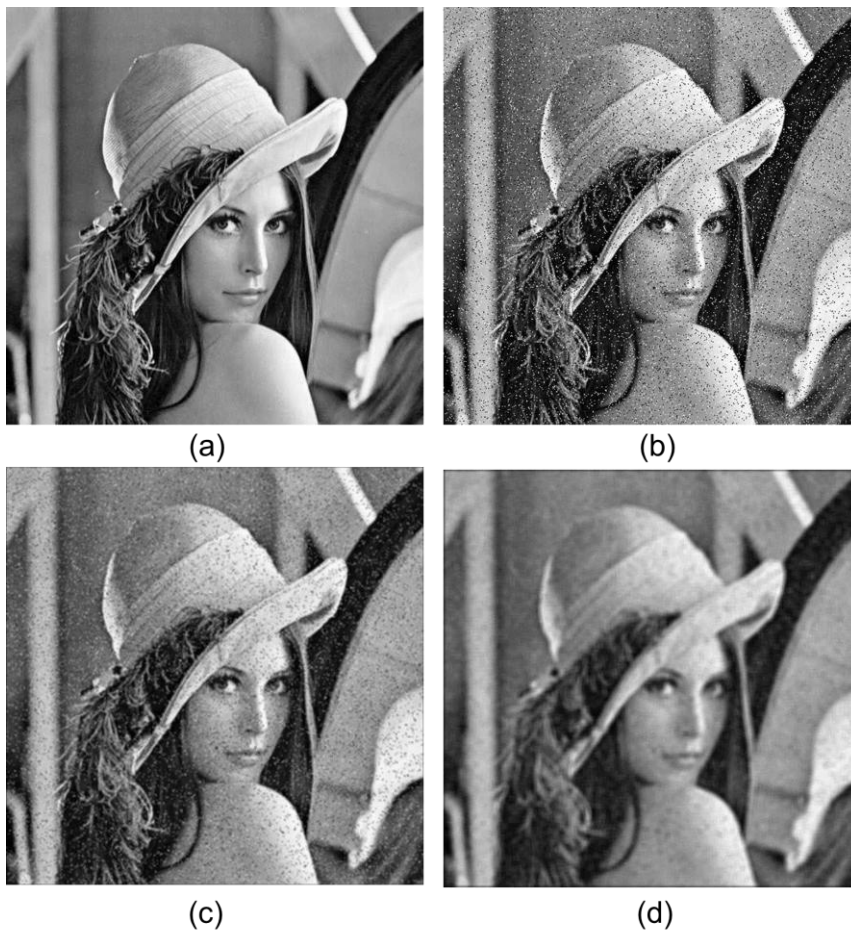
Figura 9 - Aplicação do filtro da média em imagem contaminada com ruído “sal e pimenta”. Fonte: Adaptado de ROSENBERG (2013).
