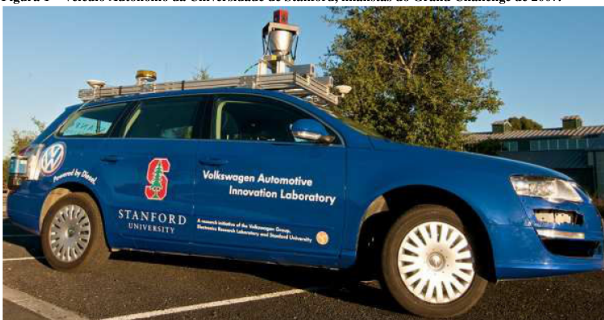
Figura 1 – Veículo Autônomo da Universidade de Stanford, finalistas do Grand Challenge de 2007.
