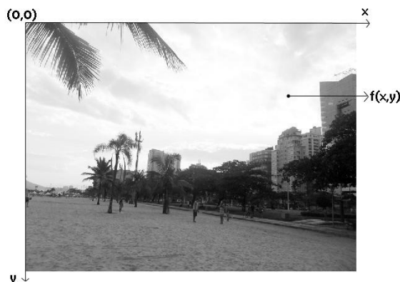
Figura 3 - Sistema de coordenadas para representação de uma Imagem Digital. Fonte: Autoria Própria.
