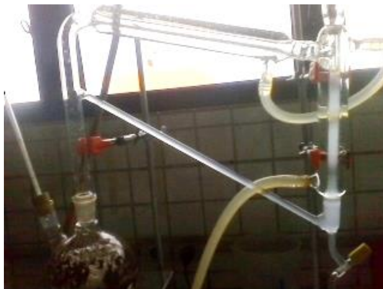
Figura 9: Aparelho tipo Clevenger utilizado na extração. Fonte: Autoria própria.
