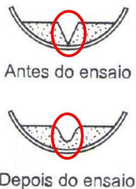
Figura 10 - Vista em corte do Prato com material de ensaio dentro.
