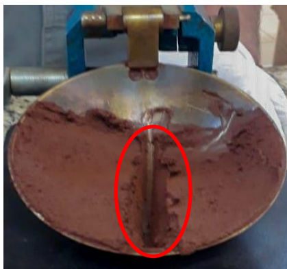
Figura 9 - Material de ensaio sobre o prato (vista em planta).
