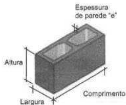
Figura 4: Bloco de concreto
