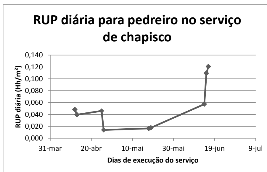
Figura 8: RUP diária para pedreiro no serviço de chapisco interno/externo.
