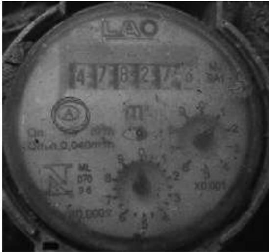
**Figura 38 - Hidrômetro com classe metrológica “A”.**
