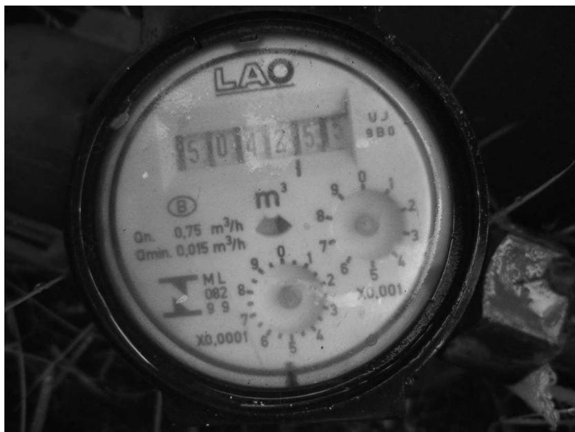
**Figura 37 - Hidrômetro Escola Municipal Tiradentes com vazão nominal de 0,75 m<sup>3</sup>/h.**
