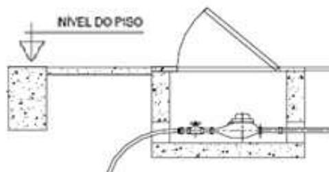
**Figura 18 - Medidor abaixo do nível piso em abrigo.**
