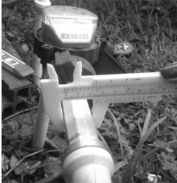
**Figura 25 - Aferição do diâmetro externo da tubulação**
