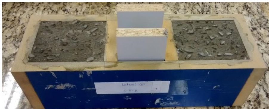
Figura 15 - Superfície da peça de B0 após tratamento superficial para exposição do agregado graúdo
