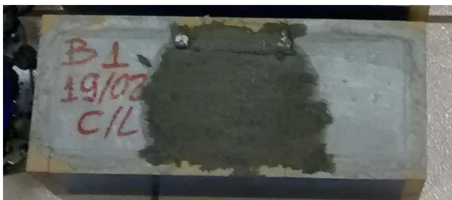
Figura 14 - Disposição da peça após a segunda etapa de concretagem Fonte: O Autor
