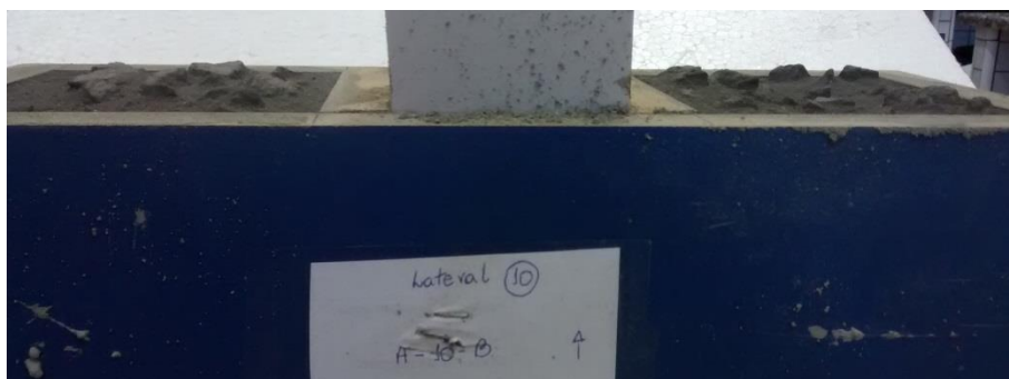
Figura 18 - Rugosidade da superfície formada pela exposição do agregado graúdo nas peças de B1
