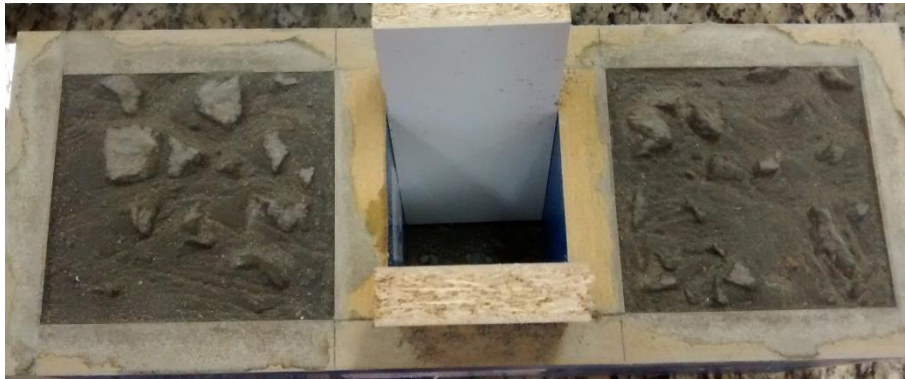
Figura 17 - Superfície da peça de B1 após tratamento superficial para exposição do agregado graúdo
