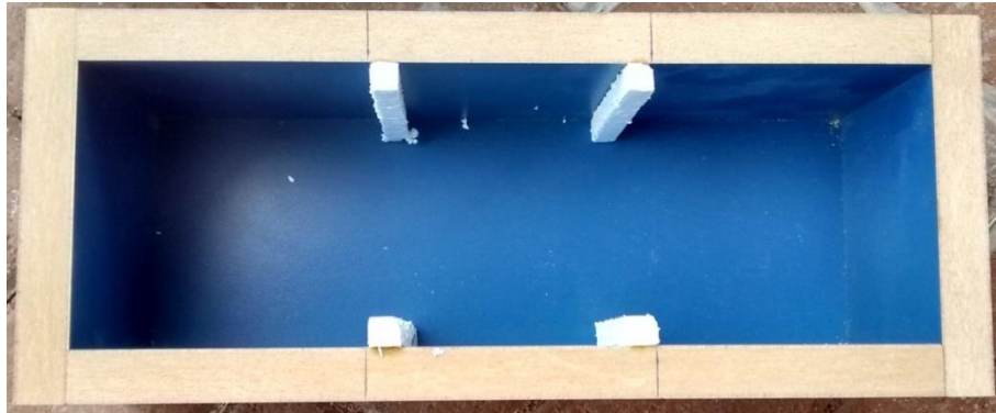
Figura 10 - Fôrma para as peças monolíticas com seção transversal reduzida por tiras de isopor
