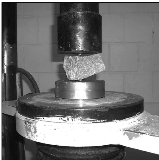
Figura 13- Ponteira de carga pontual adaptada para o ensaio. Fonte: Autor, 2017.
