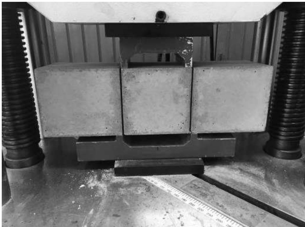
**Figura 11 - Disposição de peça prismática de concreto na prensa com o suporte metálico.**
