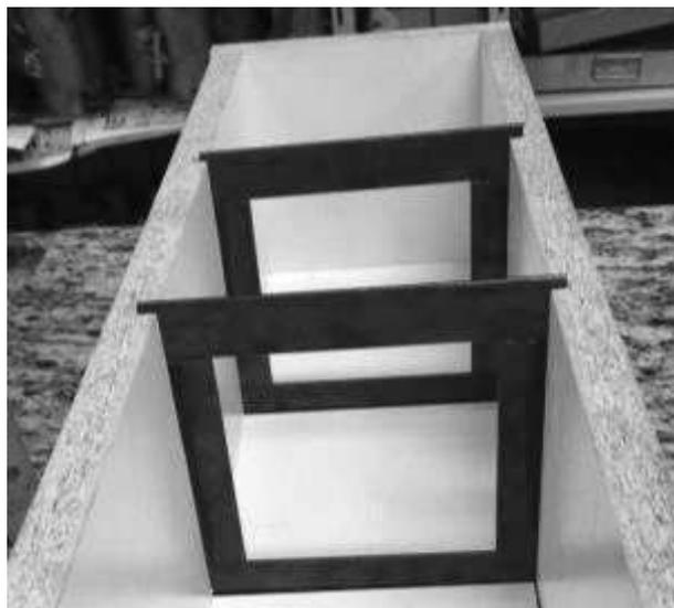
**Figura 7 - Forma para molde de corpos-de-prova prismático com barras metálicas.**
