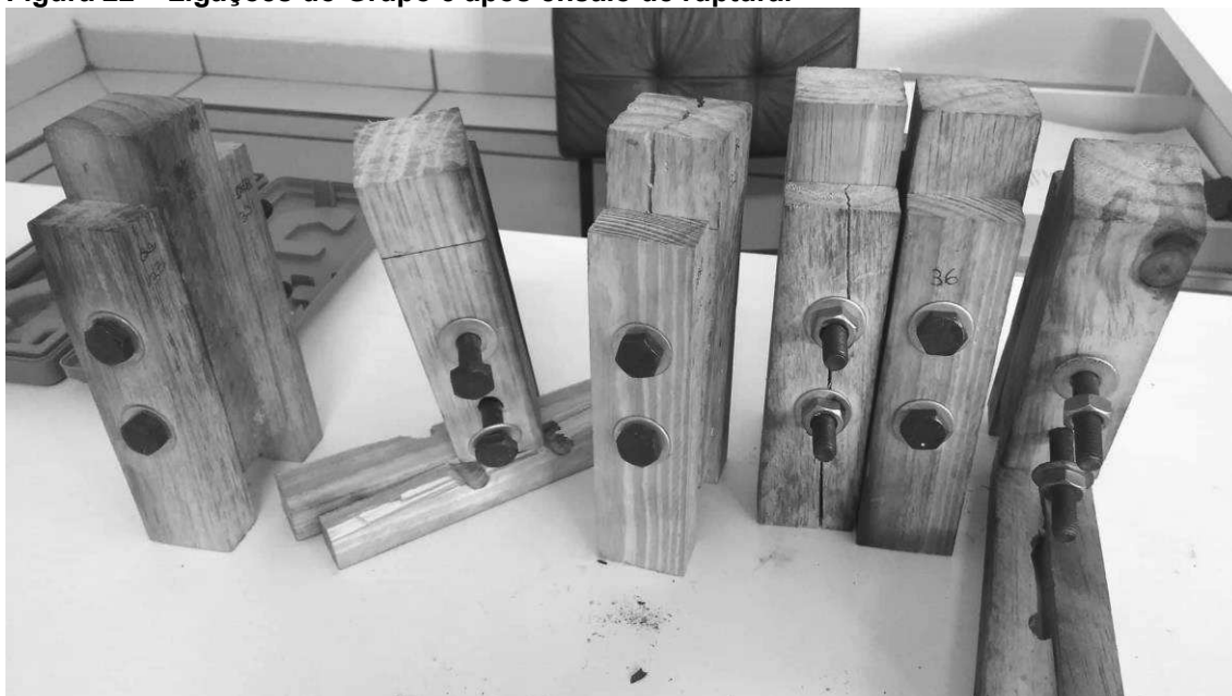
Figura 22 – Ligações do Grupo 3 após ensaio de ruptura.
