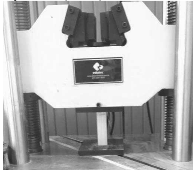
Figura 9 – Compressão paralela às fibras.
