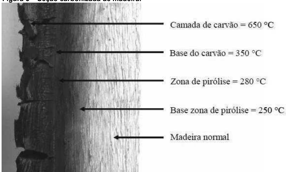
Figura 5 – Seção carbonizada de madeira.
