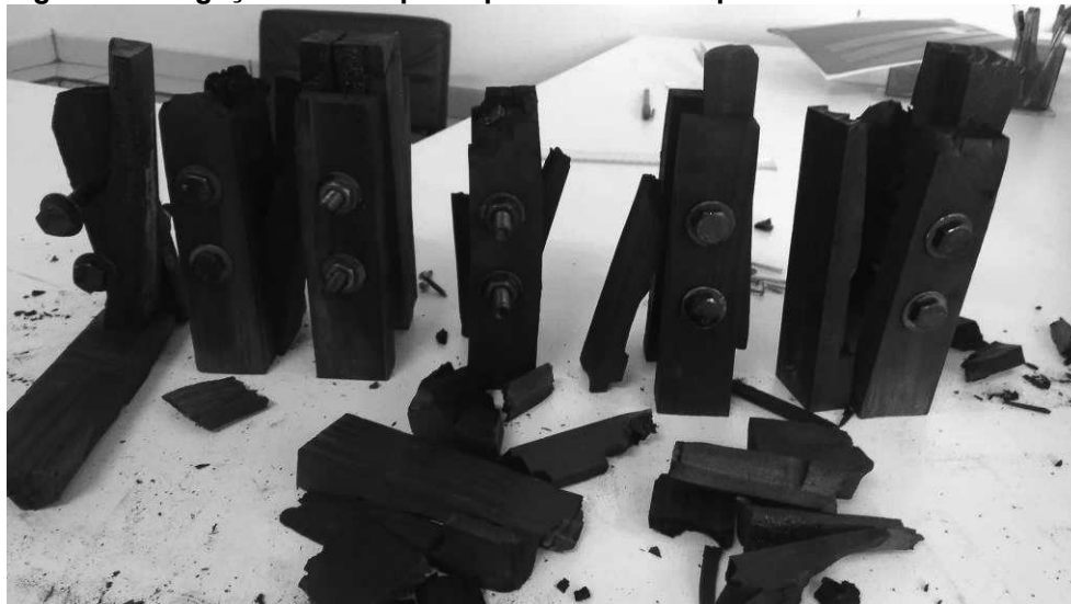
Figura 27 – Ligações do Grupo 6 após ensaio de ruptura.
