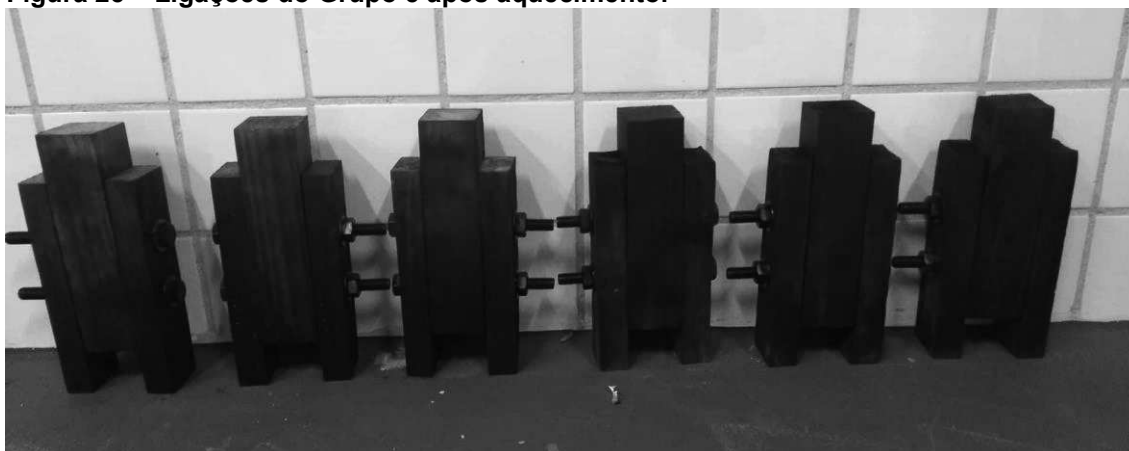
Figura 25 – Ligações do Grupo 5 após aquecimento.
