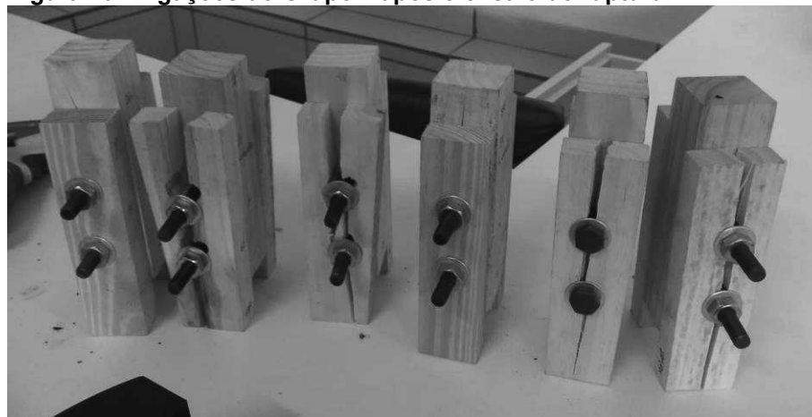
Figura 20 - Ligações do Grupo 1 após o ensaio de ruptura.
