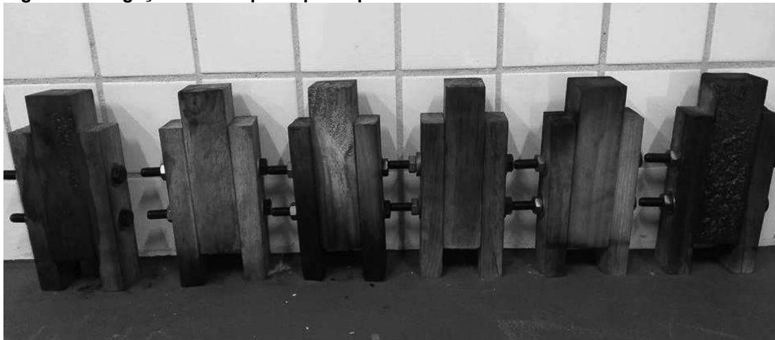
Figura 23 – Ligações do Grupo 4 após aquecimento.
