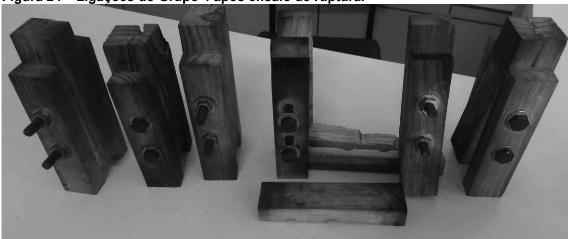
Figura 24 – Ligações do Grupo 4 após ensaio de ruptura.
