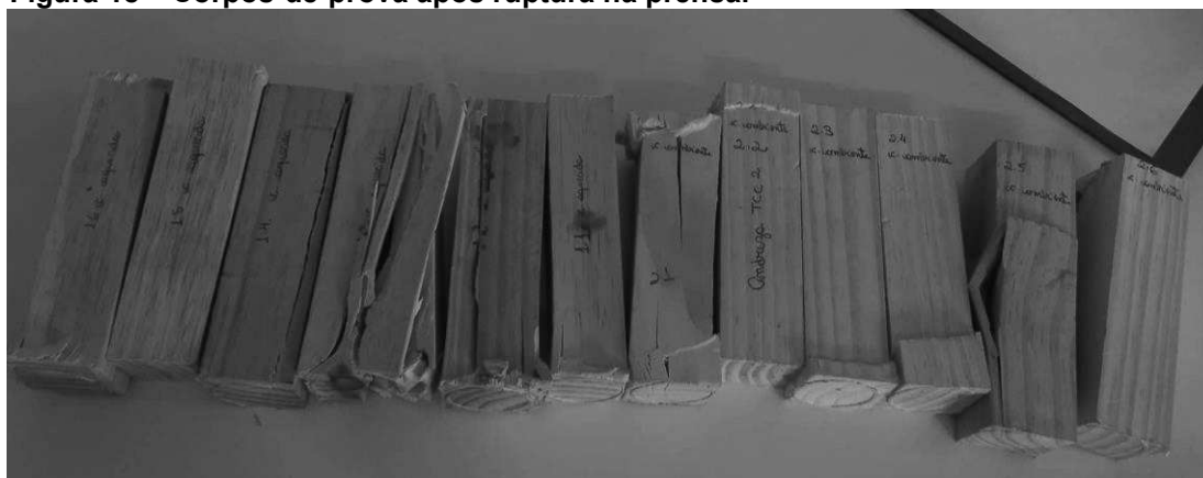
Figura 18 – Corpos-de-prova após ruptura na prensa.
