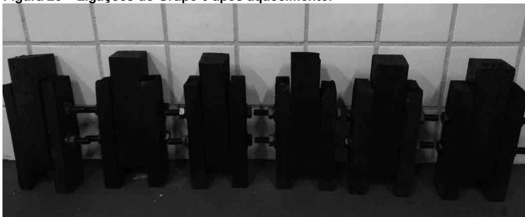
Figura 26 – Ligações do Grupo 6 após aquecimento.
