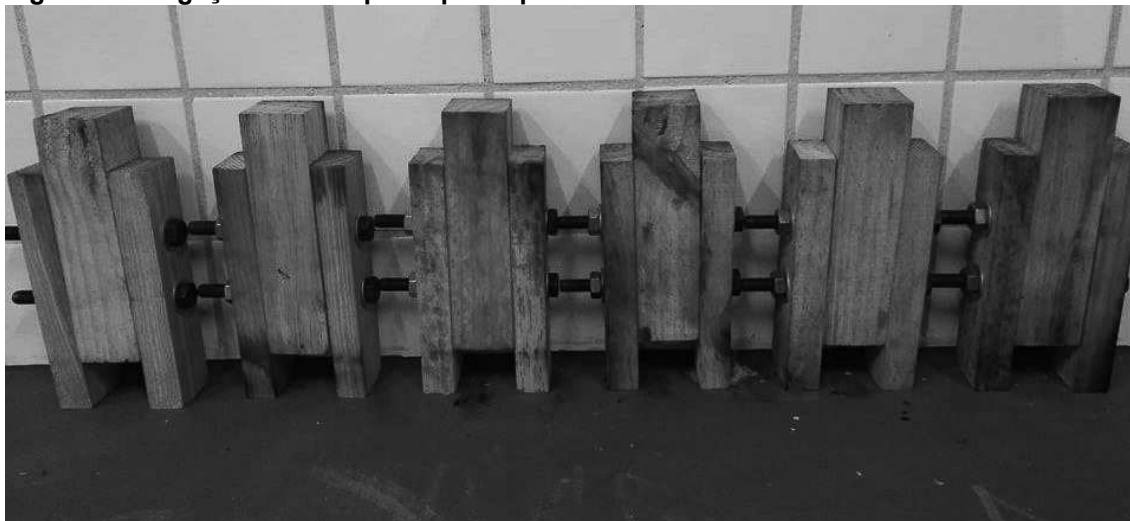
Figura 21 – Ligações do Grupo 3 após aquecimento.
