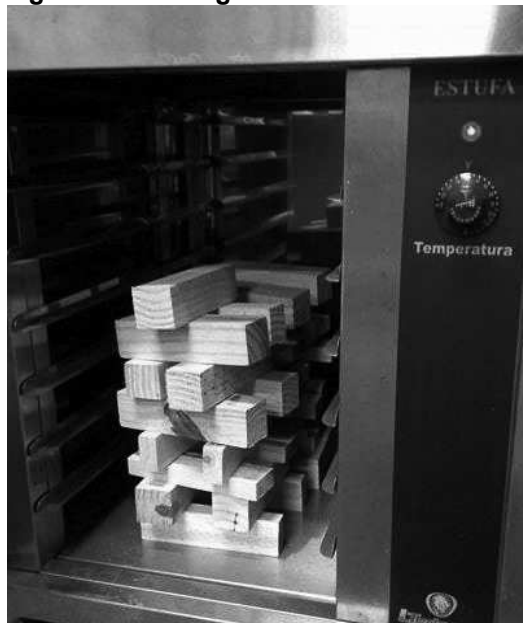
Figura 13 – Secagem das talas de madeira.
