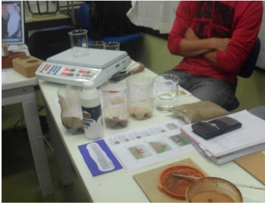
Imagem 11: Tintas à base de solo, materiais utilizados, amostras produzidas e imagens ilustrativas da utilização. Arquivo próprio e dos alunos do grupo.
