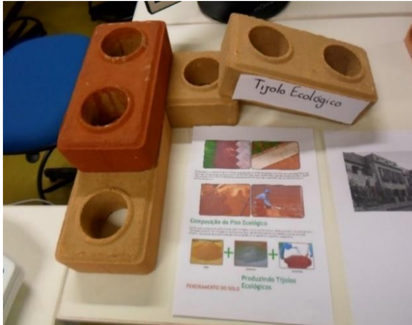
Imagem 7: Tijolo de solo cimento in-natura e pintado com tinta à base de solo Arquivo próprio e dos alunos do grupo.
