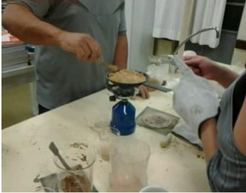
Imagem 14: Secagem do solo em chama. Arquivo próprio
