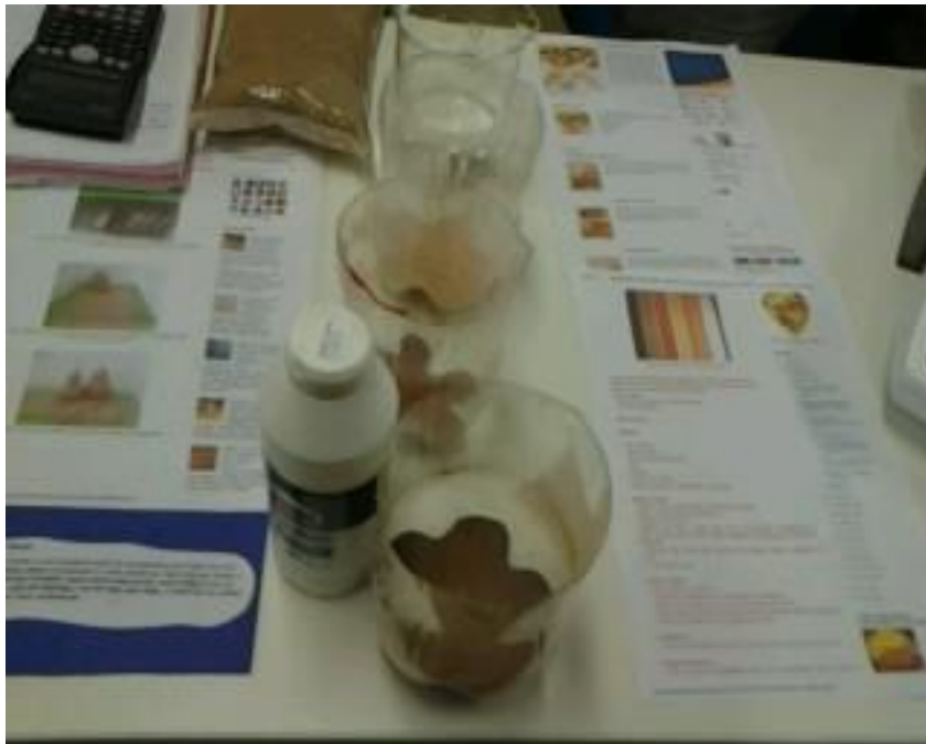
Imagem 12: Cola de madeira, solo e água, materiais utilizados para produção da tinta. Arquivo: próprio e dos alunos do grupo.
