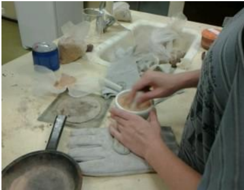
Imagem15: Trituração dos grumos de solo com auxílio do almofariz e um pistilo. Arquivo próprio
