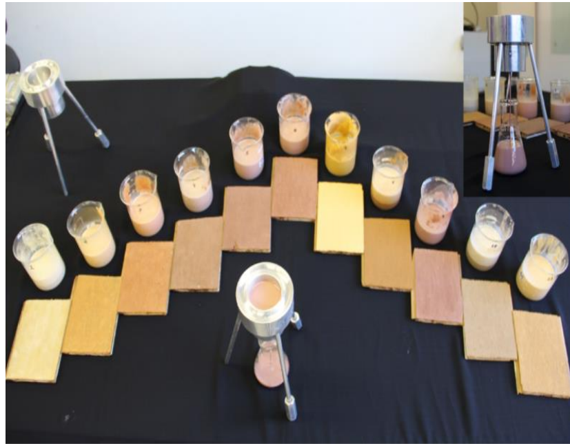
Imagem 22: Análise de viscosidade e aplicação de tintas obtidas a partir de diferentes “solos” Arquivo próprio
