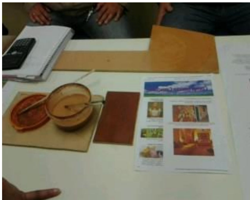
Imagem 10: Tintas produzidas a partir de solos e placas de teste de aplicação. Arquivo: próprio e dos alunos do grupo.
