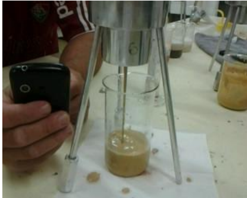
Imagem 21: Análise de viscosidade em Cup Ford número 2 Arquivo próprio
