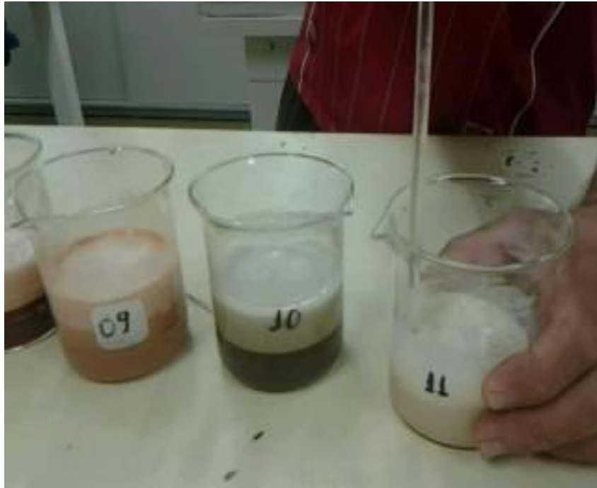
Imagem 19: Homogeneização da tinta e decantação Arquivo próprio
