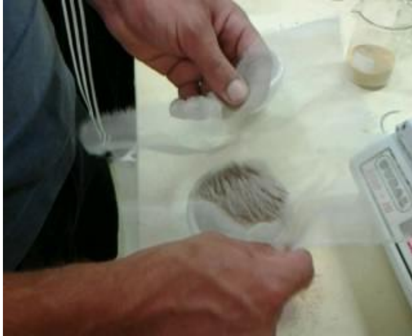
Imagem 16: Peneiração com auxílio de uma tela de nylon. Arquivo próprio
