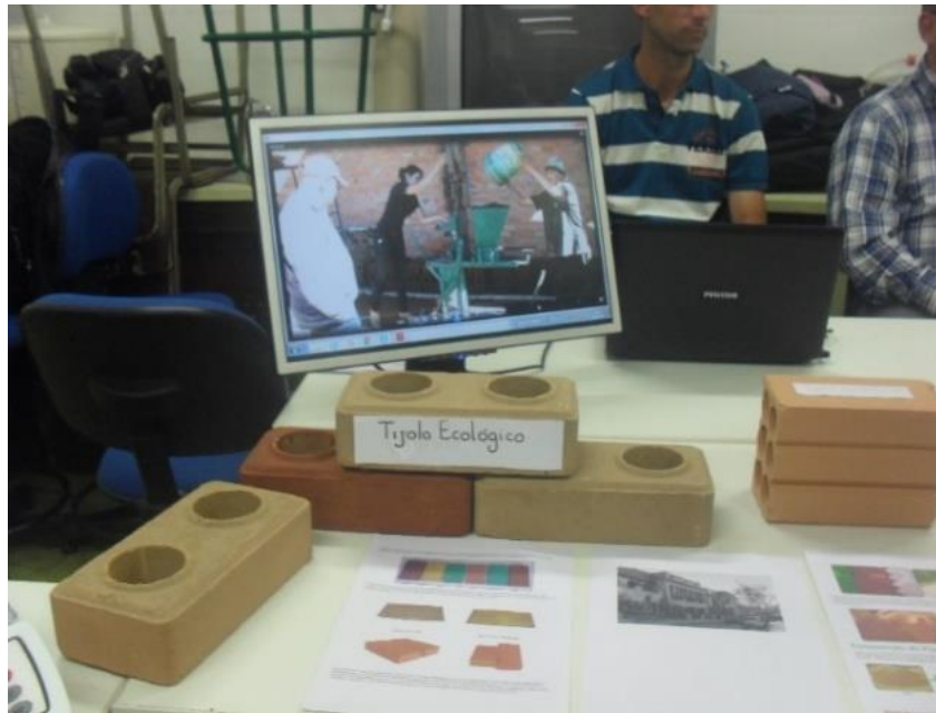
Imagem 8: Apresentação do vídeo da produção do tijolo de solo cimento, e amostras do tijolo de solo cimento e do tijolo convencional feito de barro cozido Arquivo próprio e dos alunos do grupo.
