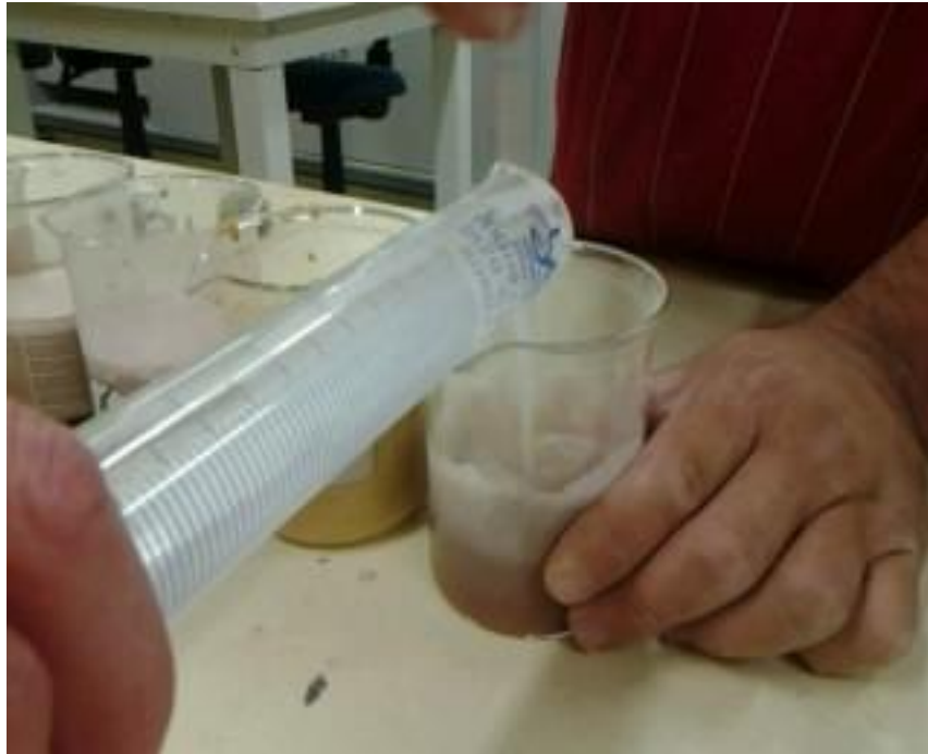
Imagem 18: Adicionando água e cola ao solo Arquivo próprio
