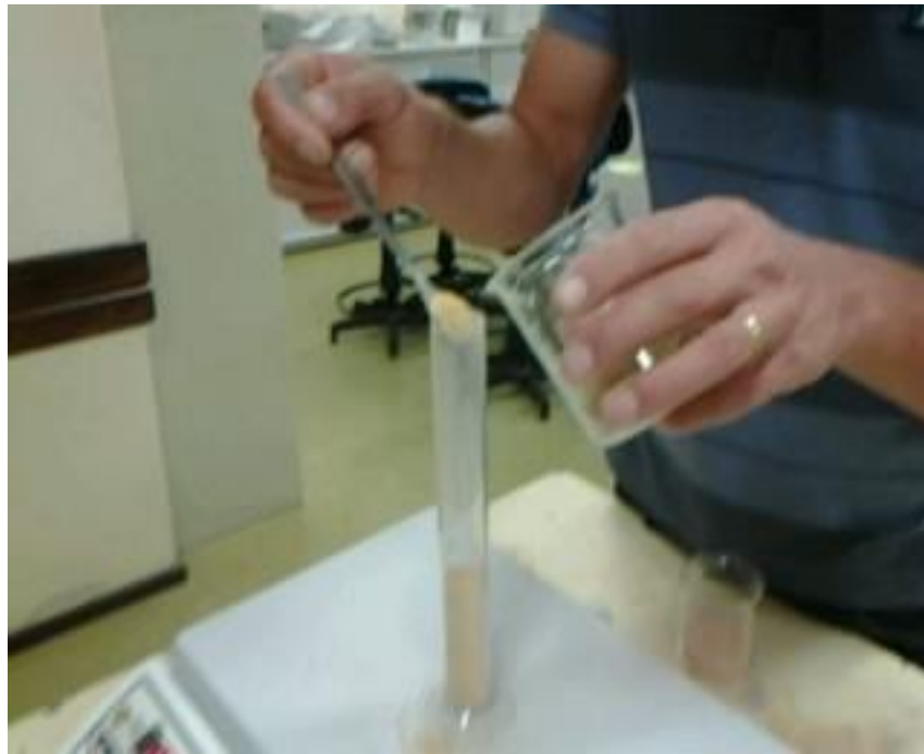
Imagem17: Pesagem em proveta para medir concomitantemente o volume. Arquivo próprio
