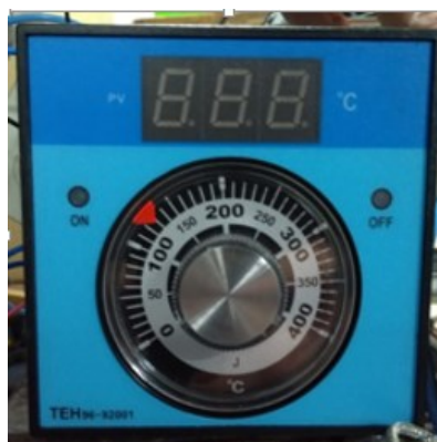
Figura 24 - Controlador de temperatura analógico com painel digital.
