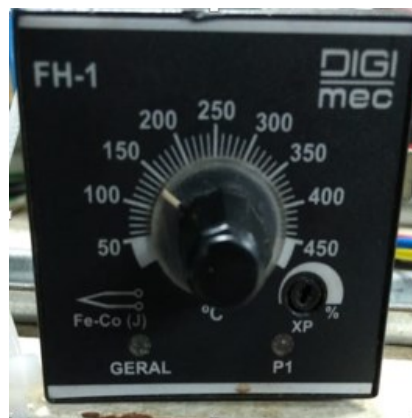
Figura 23 - Controlador de temperatura analógico.
