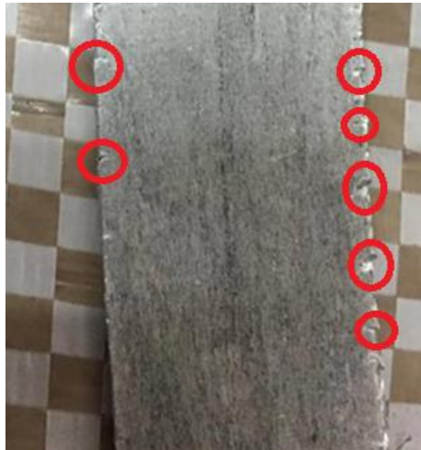
Figura 15 – Corpo de prova #6 com trincas laterais
