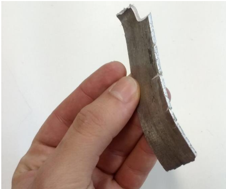
Figura 17 – Empenamento do corpo de prova
