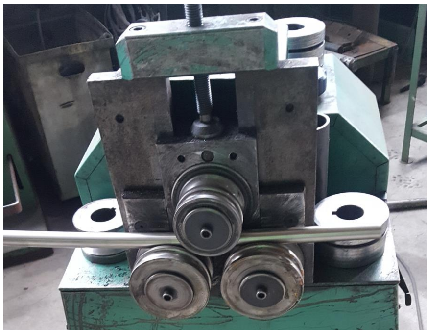
Figura 26 - Tubo no início da calandragem
