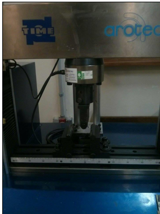
Figura 17 - Configuração da máquina de ensaios universal para o ensaio de dobramento.
