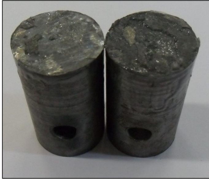
Figura 36 - Corpo-de-prova de adesão 5050 após ensaio.
