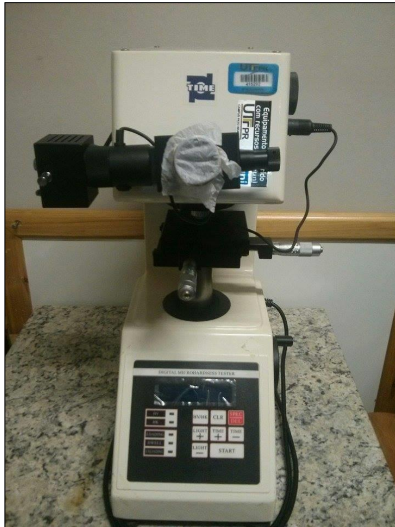
Figura 21 – Microdurômetro que será utilizado para as medições de dureza Vickers.
