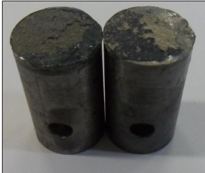
Figura 35 - Corpo-de-prova de adesão 2 camadas após ensaio.
