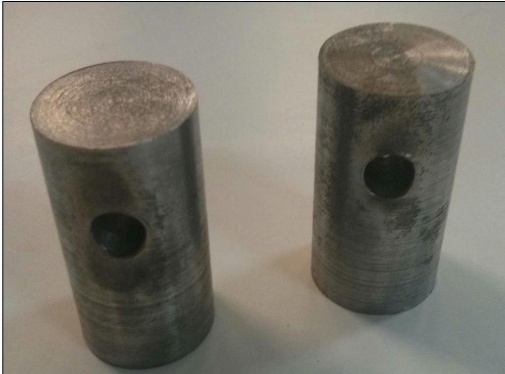
Figura 28- Corpo-de-prova de adesão antes da aspersão térmica.
