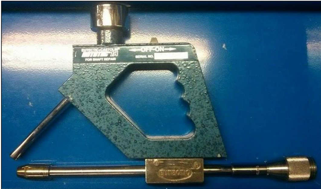
Figura 10 - Tocha de aspersão utilizada no experimento.
