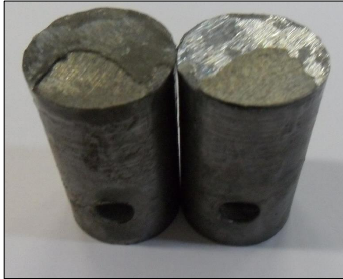
Figura 34 - Corpo-de-prova de adesão UltraBond 25000 após ensaio.
