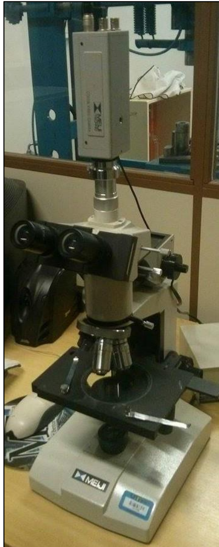
Figura 24 - Microscópio óptico utilizado para análise metalográfica.
