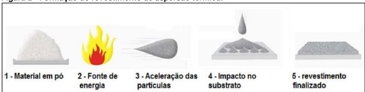
Figura 2 - Formação do revestimento de aspersão térmica.
