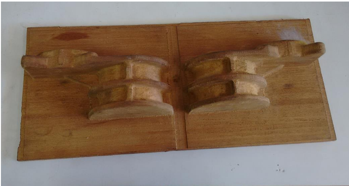
Figura 19 - Modelo bipartido da peça Base após usinagem no centro de usinagem CNC.
