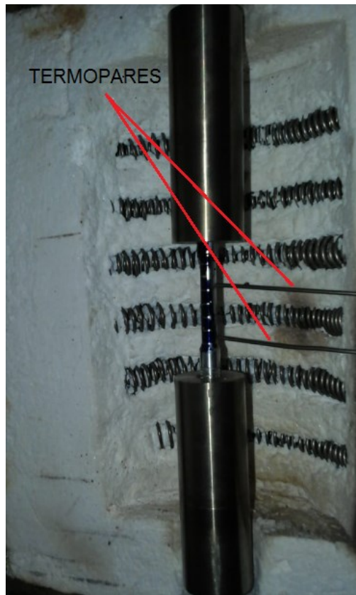
Figura 31 - Disposição Termopares dentro do Forno
