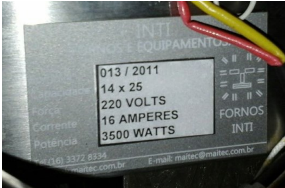
Figura 29 - Dados Forno elétrico INTI – FT 1200 R
