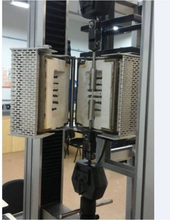
Figura 35 Montagem do Conjunto de Ensaio na Máquina de Tração
