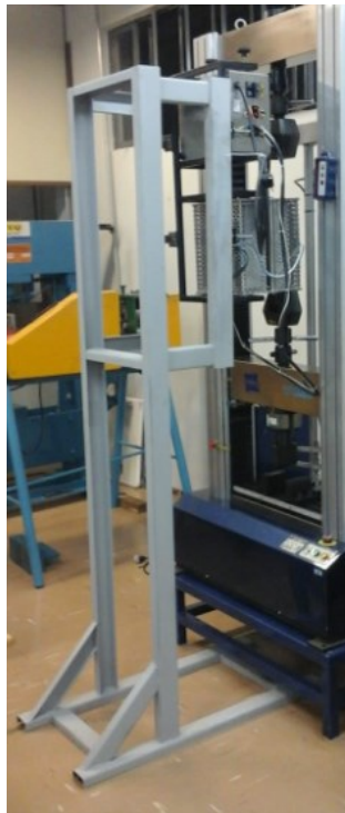
Figura 38 - Montagem da Estrutura e Acoplamento do forno.
