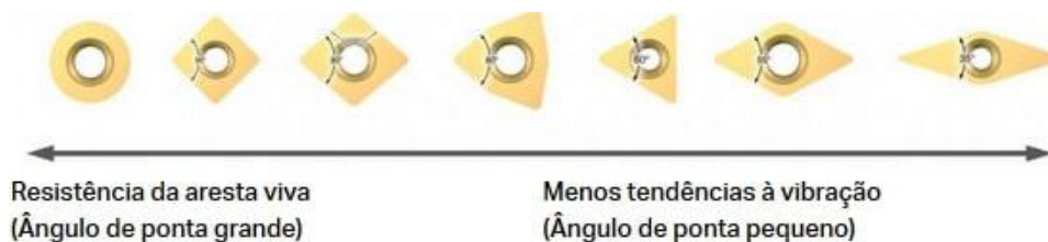
Figura 13 – Resistência mecânica e tendência a vibração de um inserto de acordo com sua geometria
