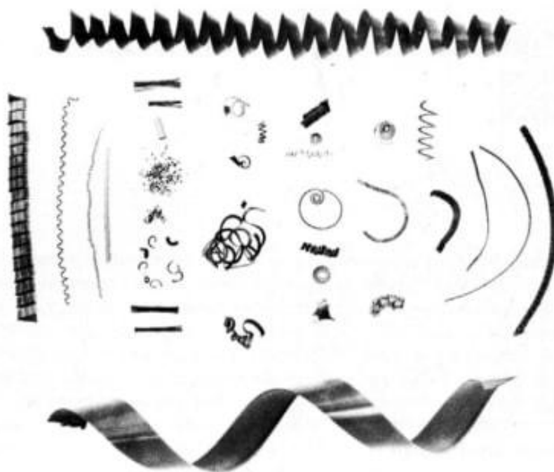
Figura 10 – Os diversos tipos de cavaco
