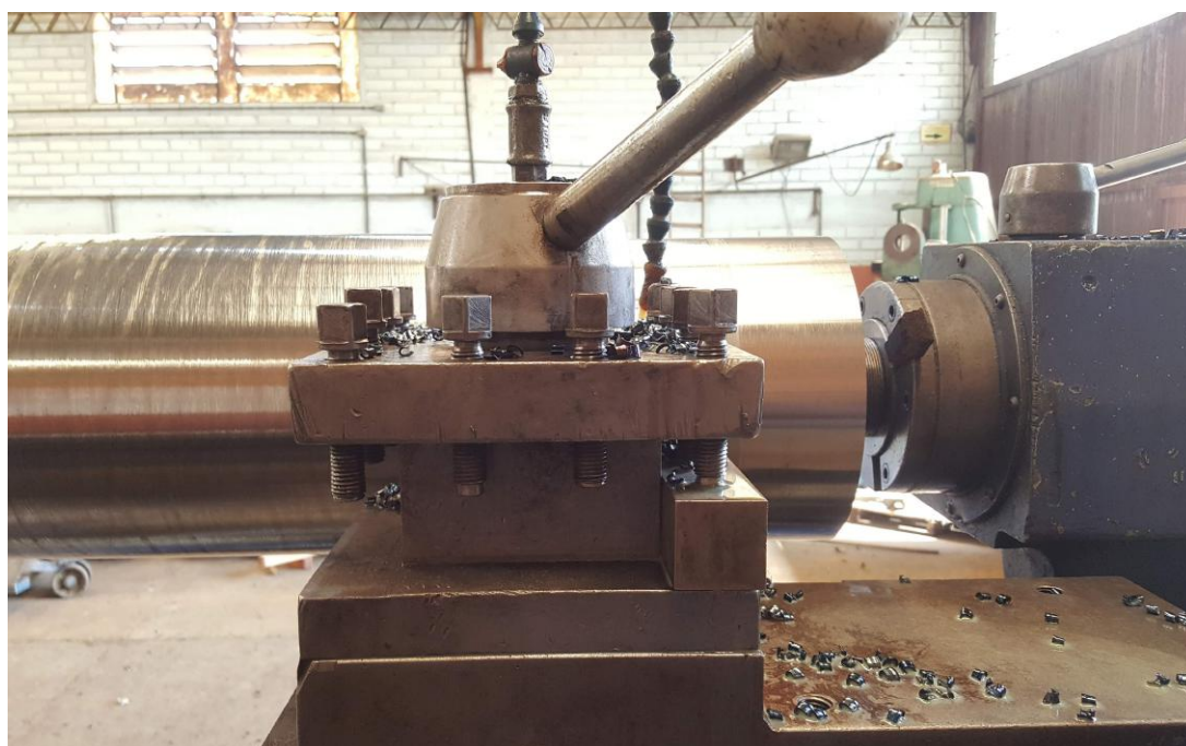
Figura 50 – Qualidade superficial provocada pela melhoria da morfologia dos cavacos
