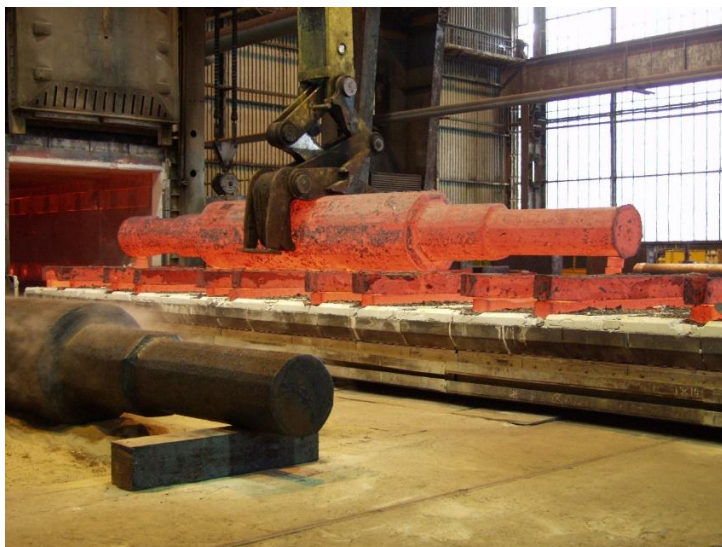
Figura 16 – Eixo forjado em matriz aberta
