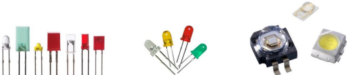
Figura 1: Exemplos de LEDs de cada classificação: Sinalização, alto brilho e de potência respectivamente.
