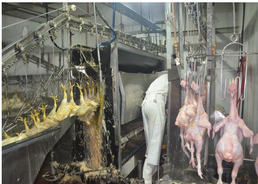
ANEXO A: Frango saindo do processo de escaldagem e entrando na depenadeira. Fonte: (PAZ, 2014)
