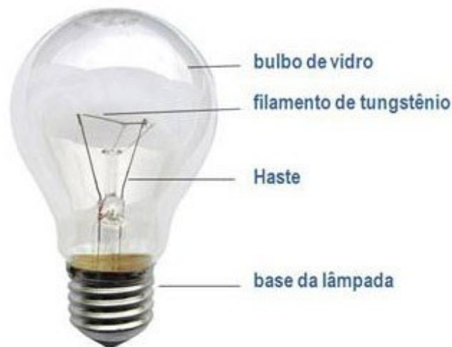
Figura 10 - Características construtivas da lâmpada incandescente Fonte: Extraído de (LUMILÂNDIA, 2016)
