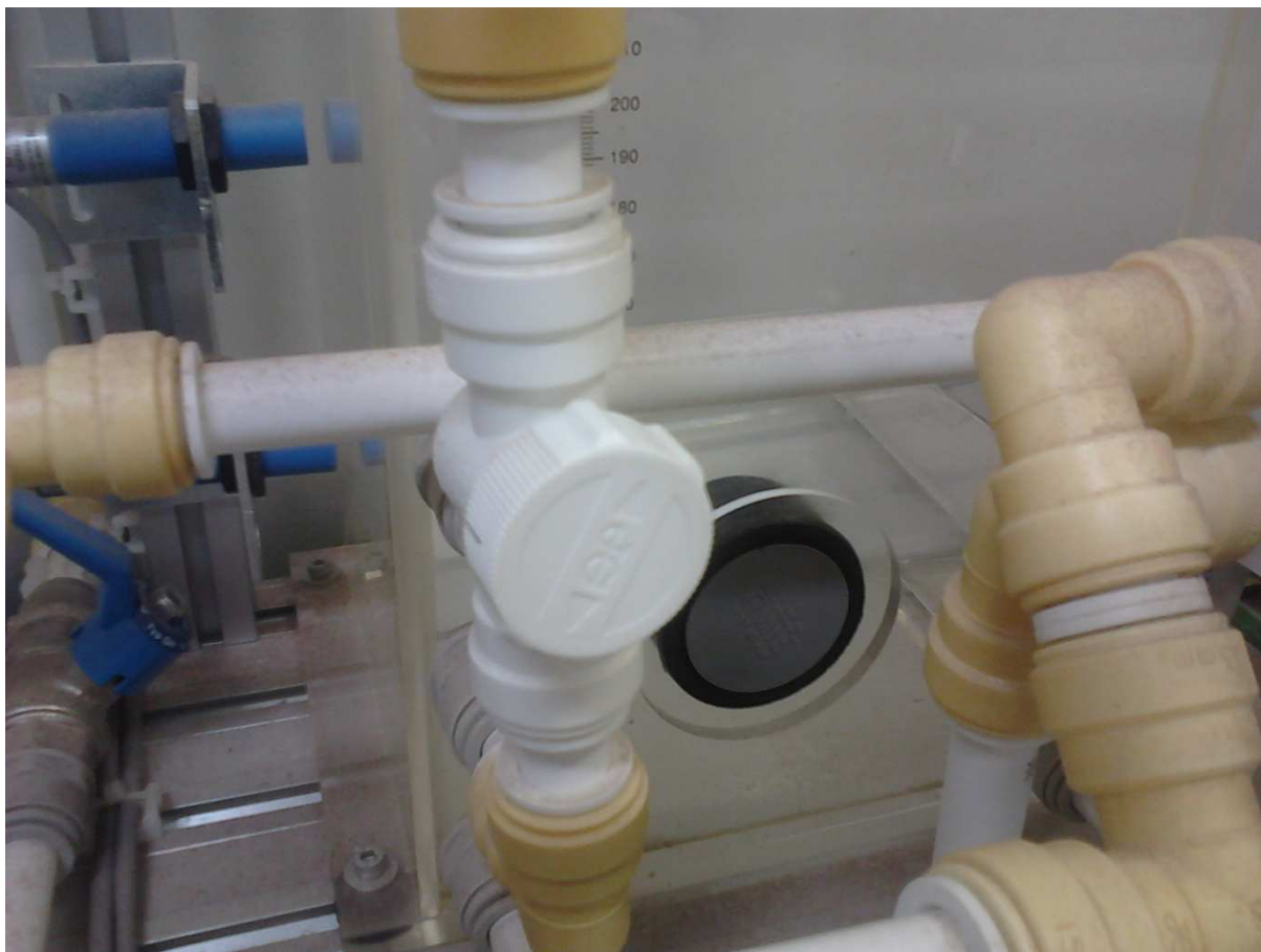
Figura 40 - Posição da válvula de vazão para definição do ponto de operação. Fonte: Autoria própria (2014).
