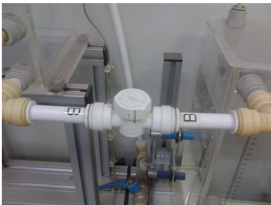
Figura 32 - Posição da válvula de nível para definição do ponto de operação. Fonte: Autoria própria (2014).
