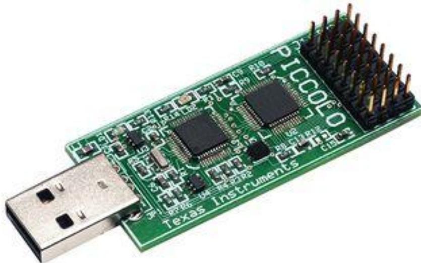
**Figura 23: Microcontrolador Piccolo controlStick**
