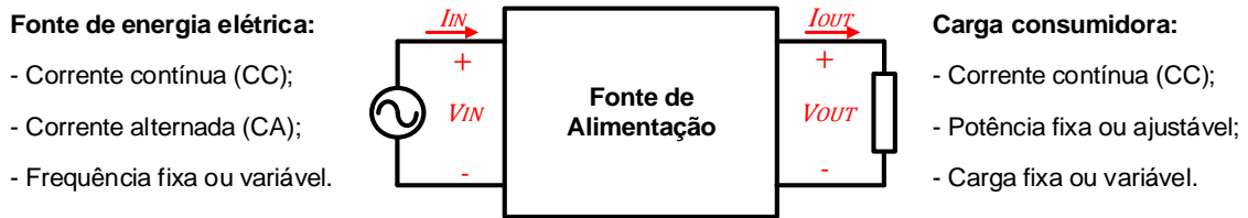
Figura 1 – Diagrama simplificado de funcionamento das fontes de alimentação. Fonte: Adaptado de Hart (2011).
