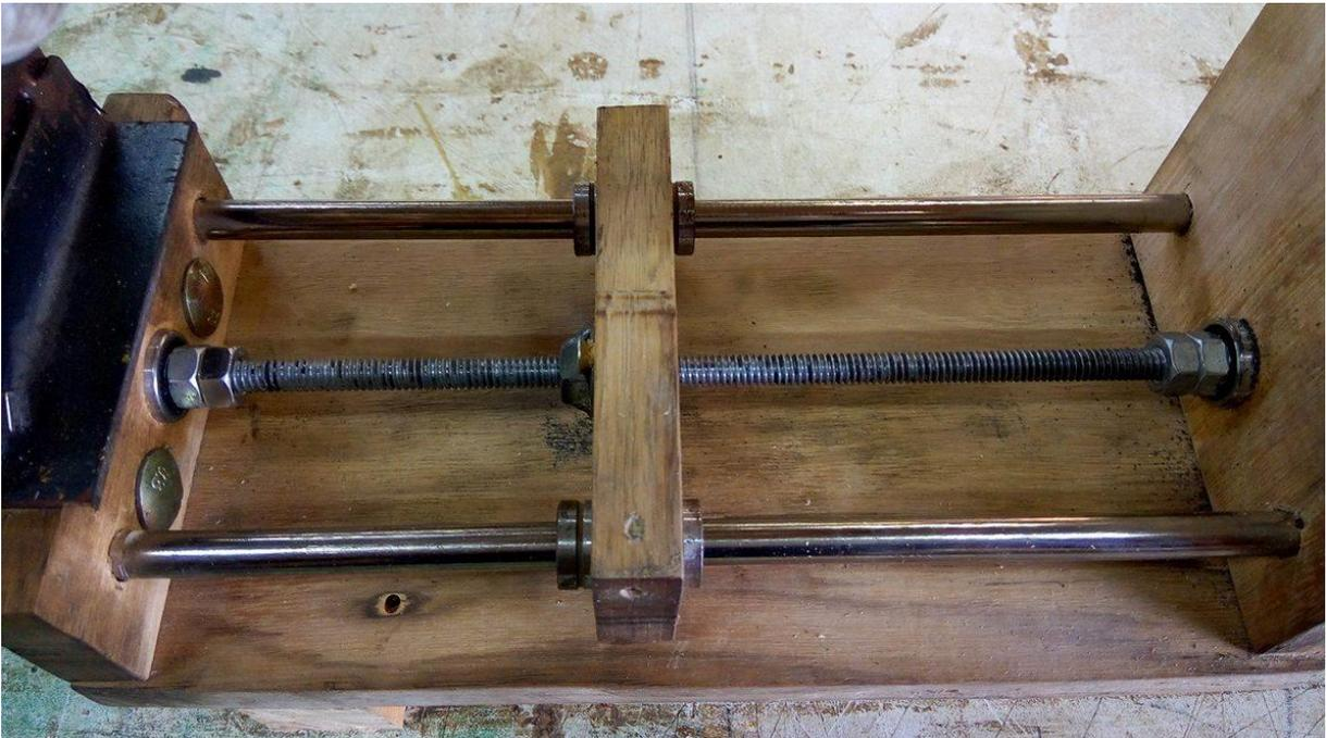
**Figura 25: Sistema de movimentação perpendicular baseado em um fuso.
