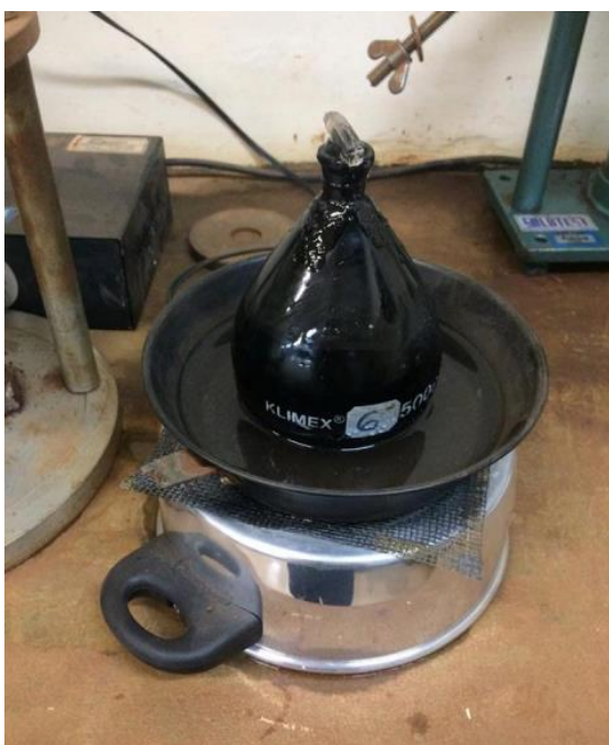
Figura 17 - Picnômetro com água destilada e ligante em banho maria
