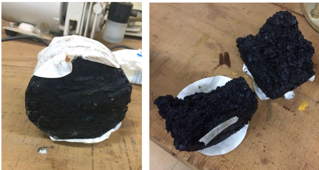
Figura 24 - Corpo de prova após a ruptura na prensa Marshall
