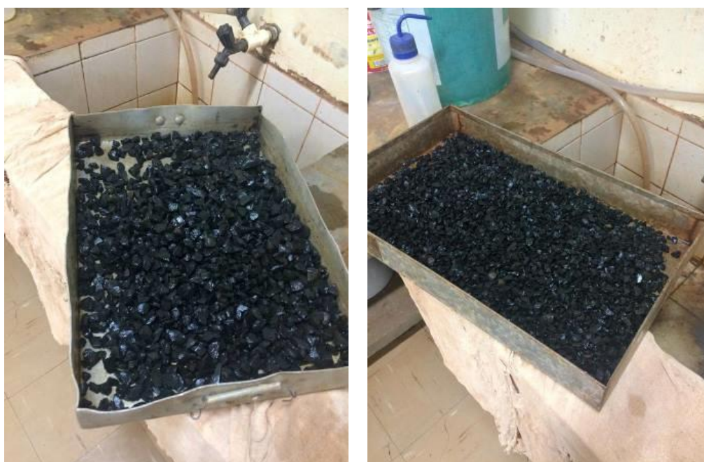
Figura 7 - Massa do agregado na condição úmida
