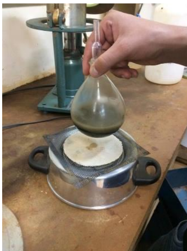
Figura 11 - Pichnômetro com amostra no fogo para expulsar o ar
