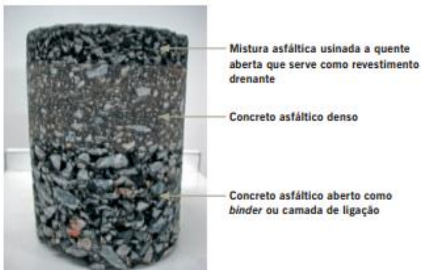
Figura 1 - Corpo-de-prova extraído de pista mostrando a composição do revestimento asfáltico (BERNUCCI et al., 2006).
