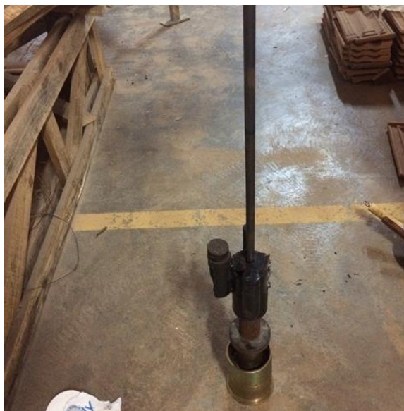
Figura 21 - Compactação do corpo de prova
