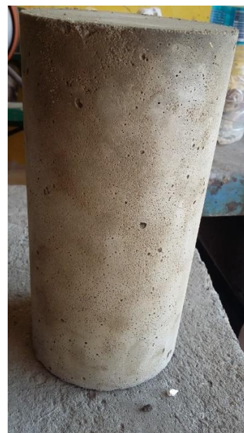
Figura 16 - CP com agregado reciclado Fonte: Autoria própria (2017).
