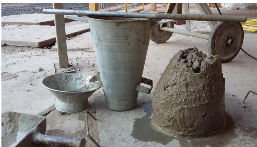
Figura 8 - Ensaio de abatimento do concreto Fonte: Autoria própria (2017).
