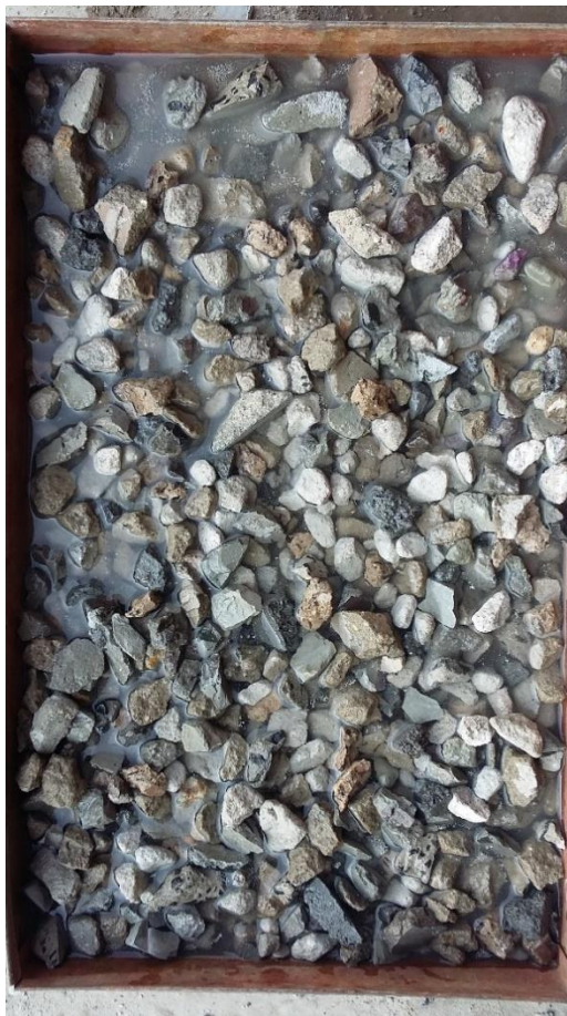
Figura 7 - Pré-molhagem de agregados reciclados Fonte: Autoria própria (2017).
