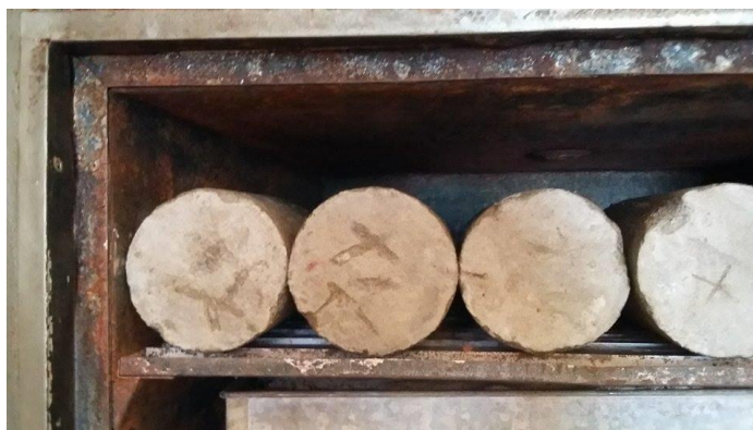
Figura 11 - Corpos de prova na estufa Fonte: Autorial própria (2017).
