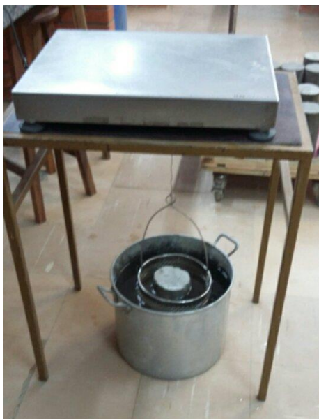
Figura 10 - Determinação da massa submersa dos corpos de prova Fonte: Autorial própria(2017).
