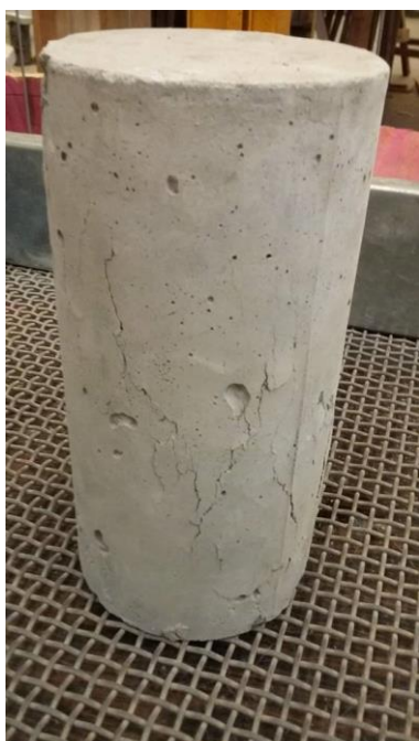
Figura 13 – Corpos de prova após rompimento Fonte: Aatoria própria (2017).
