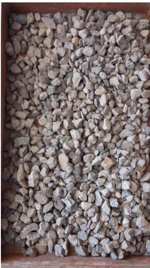
Figura 5 - Agregado natural Brita 1 Fonte: Autoria própria (2017).
