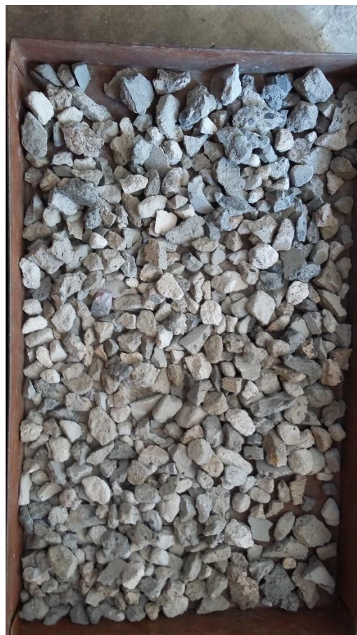
Figura 6 – Agregado reciclado Brita 1 Fonte: Autoria própria (2017).
