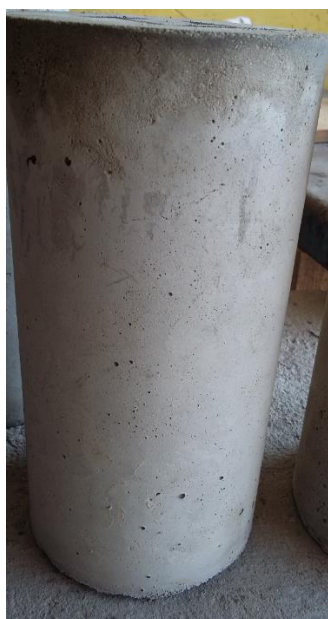
Figura 15 - CP com agregado 100% natural Fonte: Autoria própria (2017).
