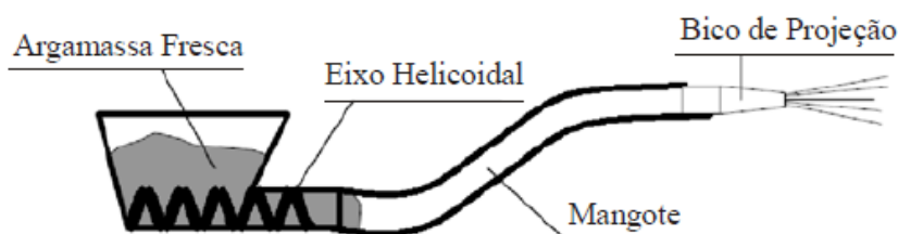
Figura 8 - Bomba de argamassa com eixo helicoidal Fonte: SANTOS, 2003.
