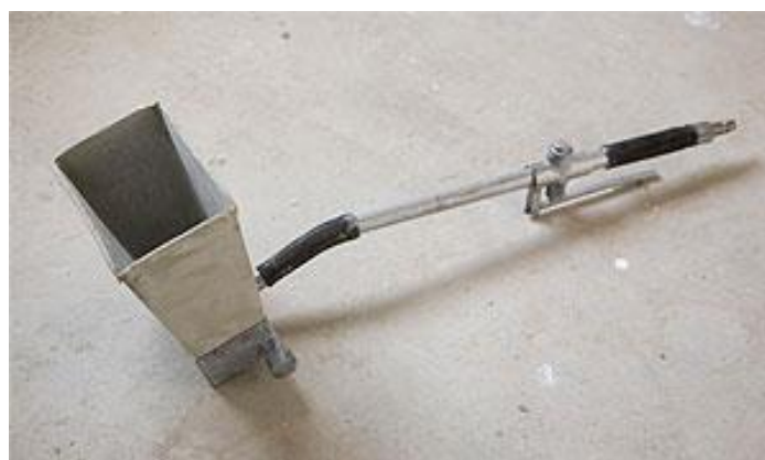
Figura 7 - Sistema de projeção com recipiente acoplado - caneca de projeção Fonte: Chichinelli (2010).
