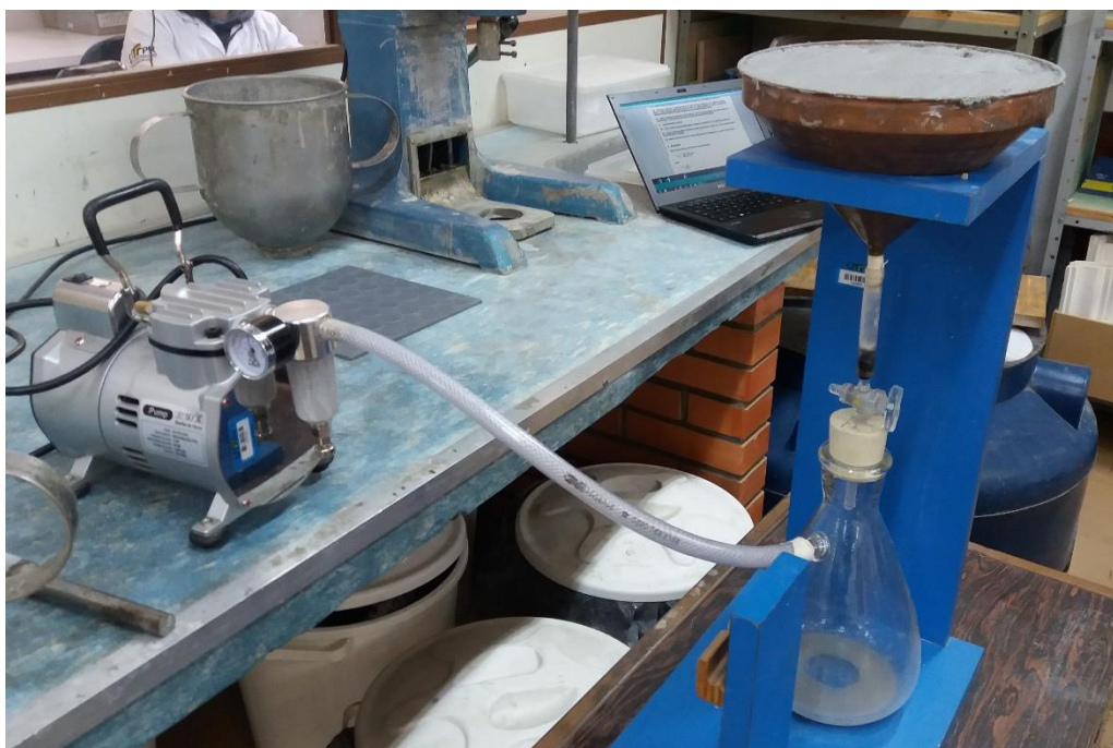
Figura 19 - Ensaio de retenção de água – equipamentos Fonte: Autoria própria (2017).
