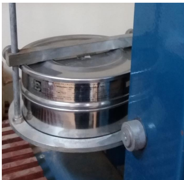
Figura 12 - Conjunto fundo+peneira+tampa no agitador de peneiras
