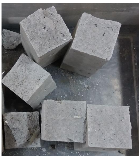
Figura 27 – Corpos de prova após o ensaio de resistência à compressão Fonte: Autoria própria (2017).
