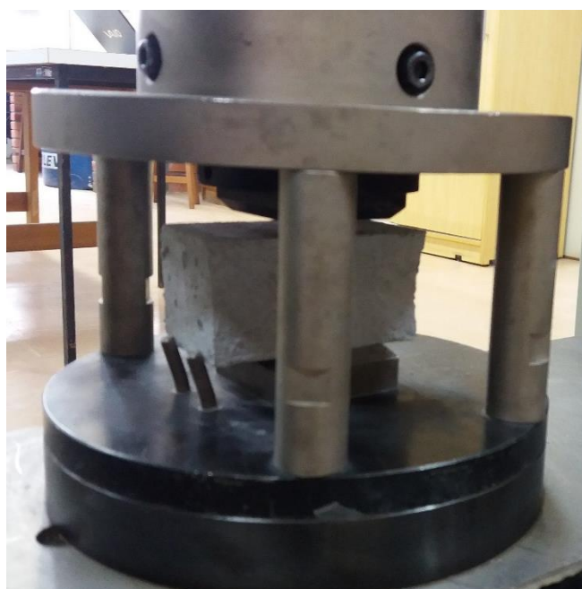
Figura 26 - Ensaio de resistência à compressão Fonte: Autoria própria (2017).
