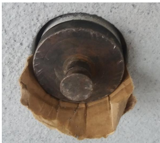
Figura 34 - Auxílio de papelão para colagem da pastilha Fonte: Aatoria própria (2017).
