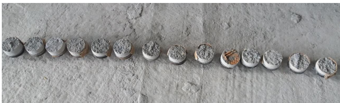
Figura 36 - Corpos de prova após o arrancamento Fonte: Autoria própria (2017).
