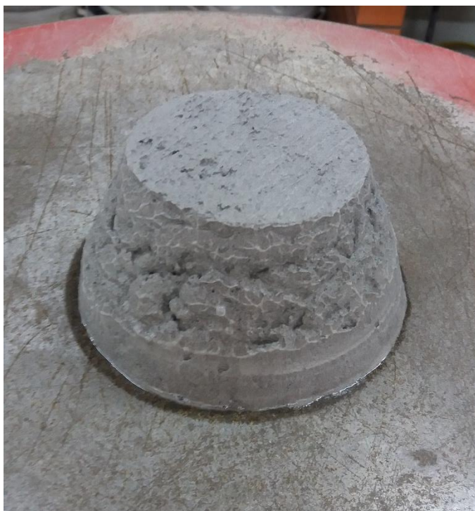
Figura 17 - Argamassa na mesa de consistência Fonte: Autoria própria (2017).
