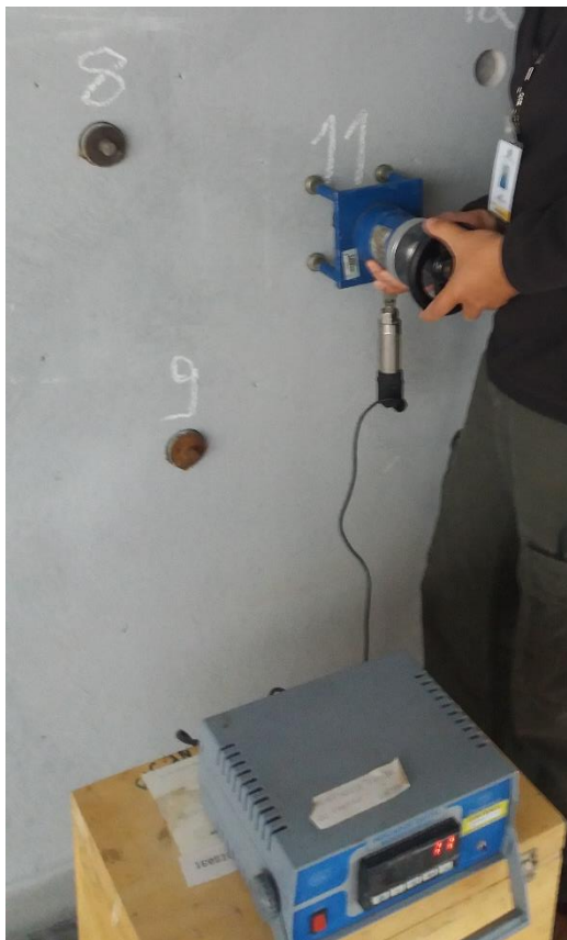
Figura 35 - Arrancamento dos corpos de prova com dinamômetro de tração Fonte: Autoria própria (2017).
