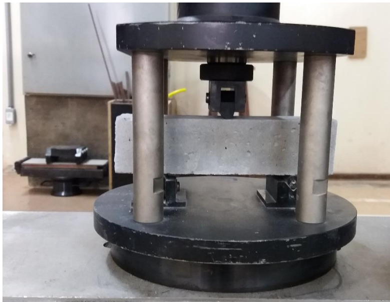
Figura 23 - Ensaio de resistência à tração na flexão Fonte: Autoria própria (2017).
