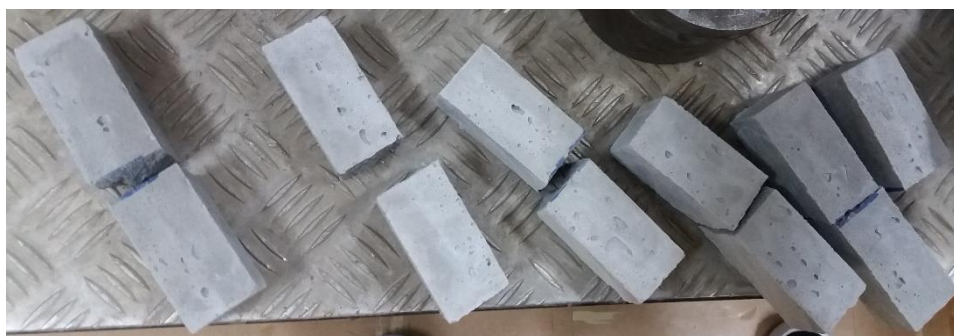
Figura 24 – Corpos de prova rompidos à tração na flexão Fonte: Autoria própria.
