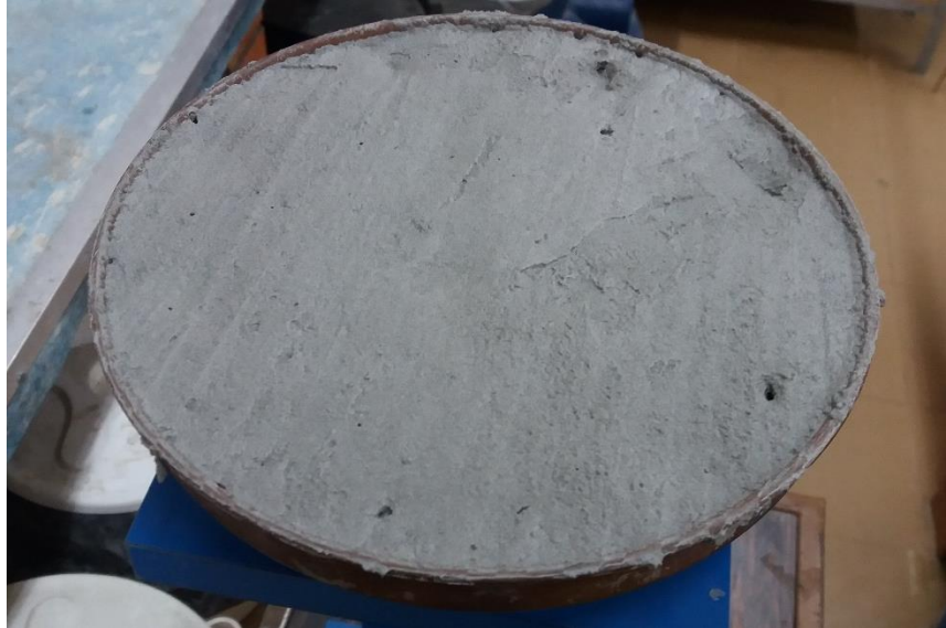
Figura 20 - Prato de argamassa após o ensaio Fonte: Autoria própria (2017).
