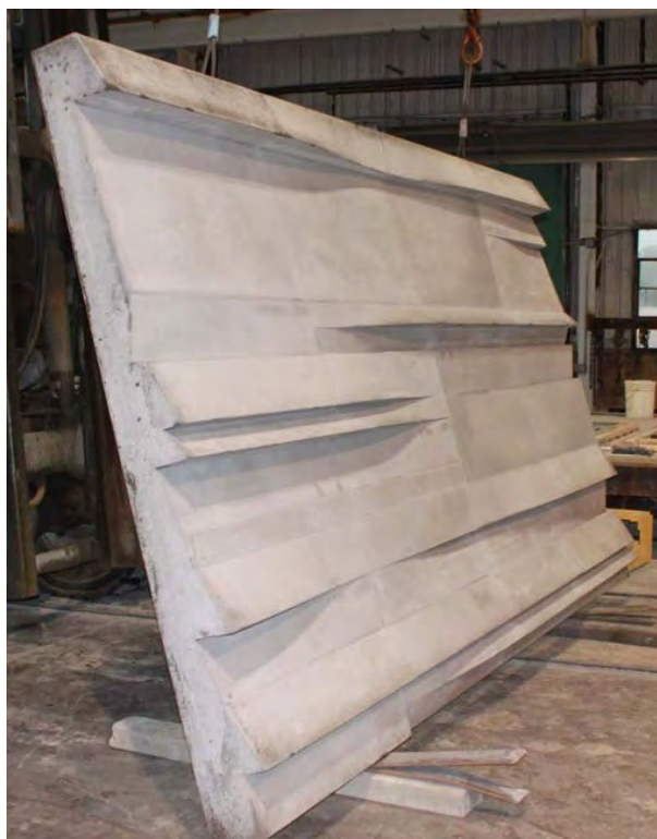
Figura 2: Painel de concreto utilizado na fachada do Perot Museum, em Dallas Fonte: (KRICHELS, 2011).
