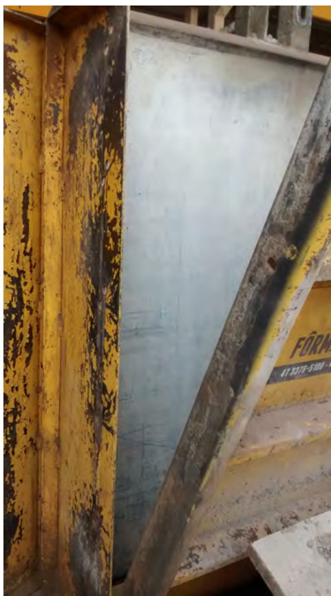
Figura 32: Fôrma utilizada na execução de placas de vedação na empresa A
