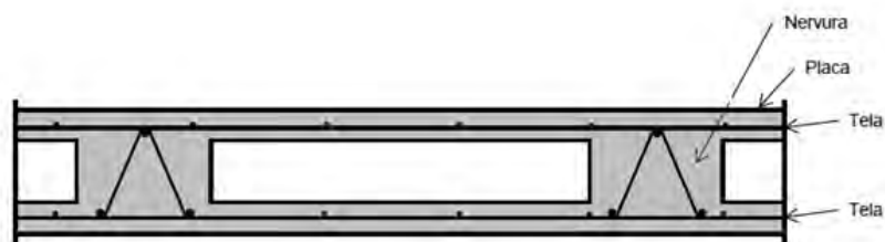
Figura 9: Seção transversal de um painel nervurador Fonte: Adaptado de (IPT, 2014)
