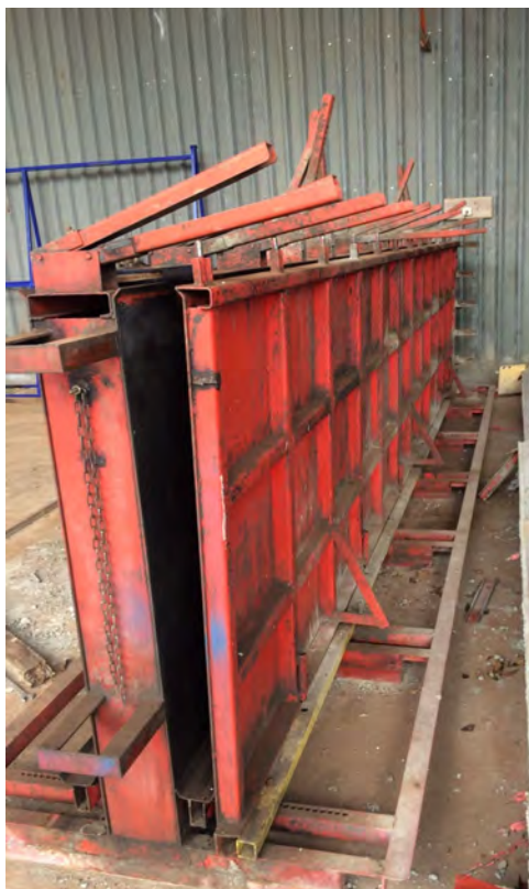
Figura 33: Fôrma utilizada na execução de placas de vedação na empresa B Fonte: Autoria Própria.
