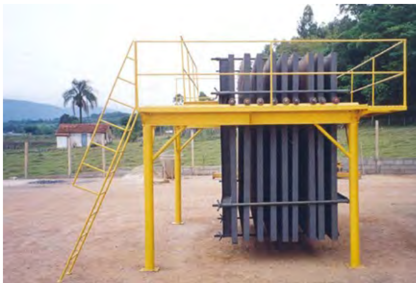
Figura 12: Fôrmas do tipo bateria utilizadas para a fabricação dos painéis
