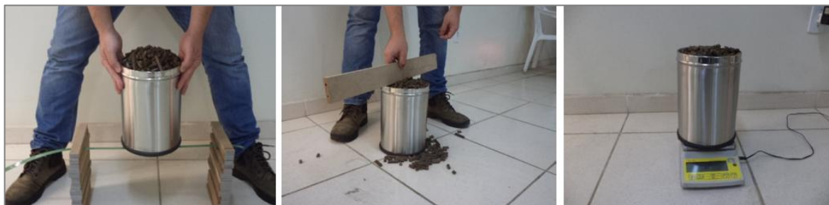
Figura 10 - Teste da densidade a granel dos pellets
