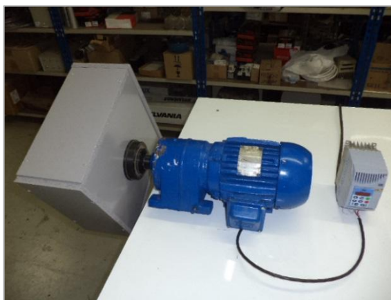
Figura 12 - Dispositivo utilizado para teste de durabilidade dos pellets
