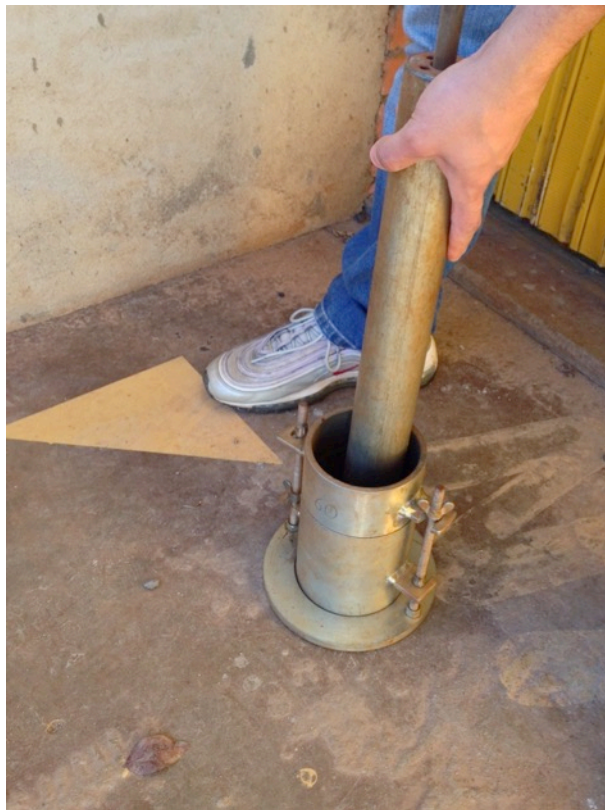
Figura 13 - Compactação de amostra com soquete pequeno
