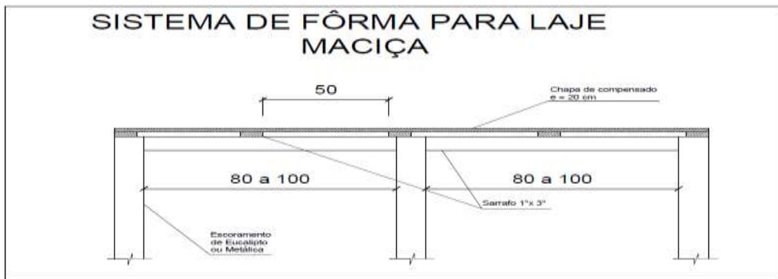
Figura 31: Detalhe representativo do sistema de fôrma para Laje Maciça. Fonte: Autoria própria 2015.
