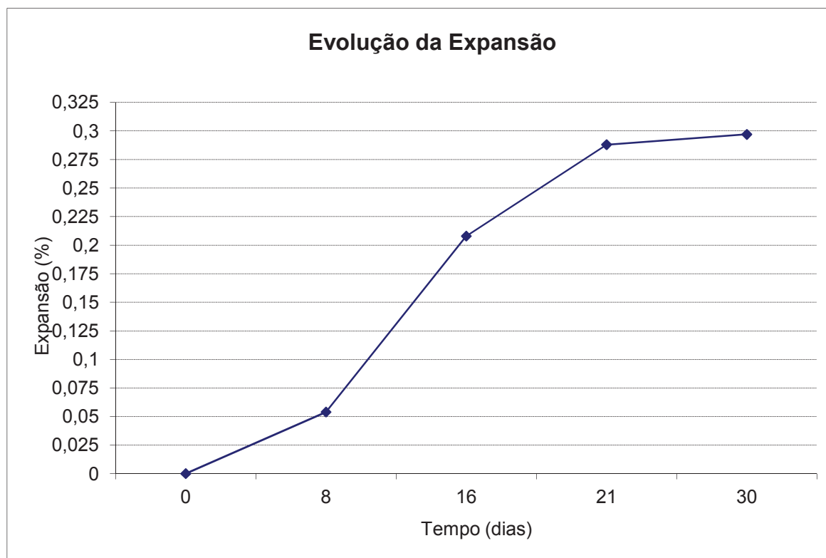
Figura 18 – Evolução da Expansão das Barras de Agregado Reativo até 30 dias. Fonte: Autoria própria.
