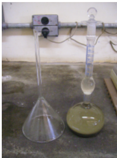
Figura 5 – Ensaio de Massa Específica do Cimento. Fonte: Autoria Própria.
