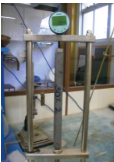
Figura 15 - Leitura Inicial da Barra de Argamassa. Fonte: Autoria Própria.
