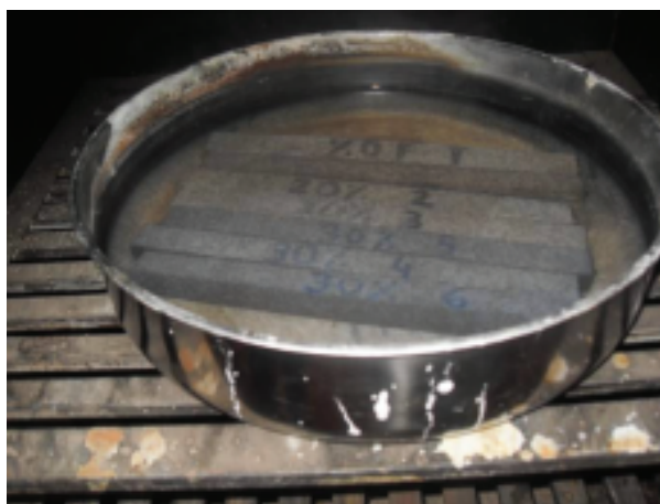
Figura 16 - Barras de Argamassa Imersas na Solução de NaOH. Fonte: Autoria Própria.
