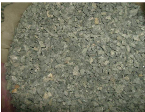
Figura 2 – Rocha basáltica utilizada nos ensaios. Fonte: Autoria Própria.
