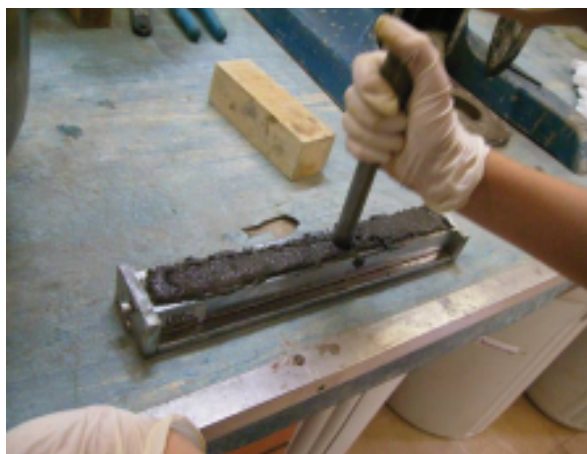
Figura 13 - Moldagem das Barras de Argamassa. Fonte: Autoria Própria.
