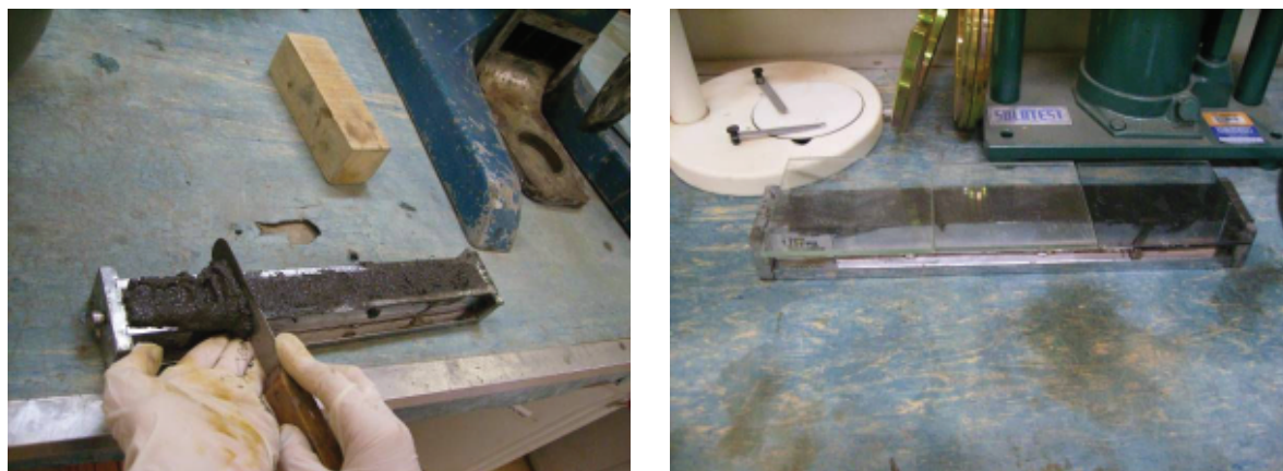
Figura 14 - Rasamento e Cobertura da Barra Moldada. Fonte: Autoria Própria.
