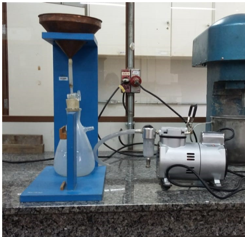
Figura 6: Funil de Buchner com bomba à vácuo.
