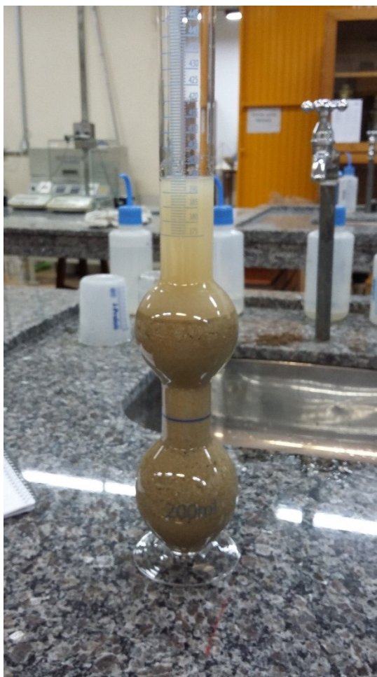
Figura 3: Determinação de massa específica por frasco de Chapman.
