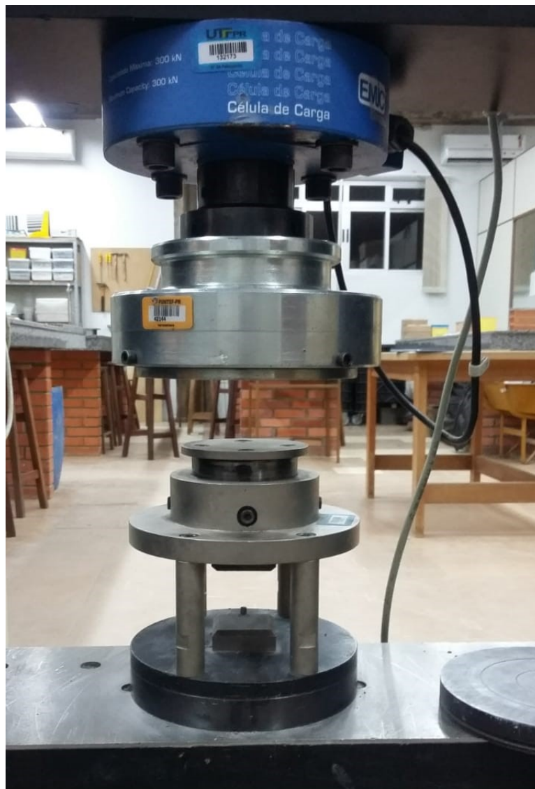
Figura 9: EMIC DL 30000 equipada com dispositivo para ensaio de resistência à compressão.
