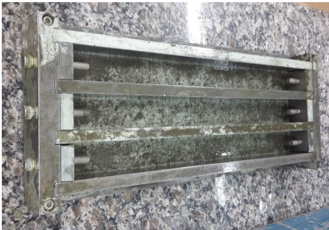
Figura 10: Molde 25 mm x 25 mm x 285 mm.
