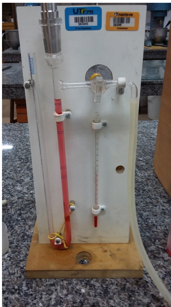
Figura 2: Equipamento de realização do ensaio Blaine.
