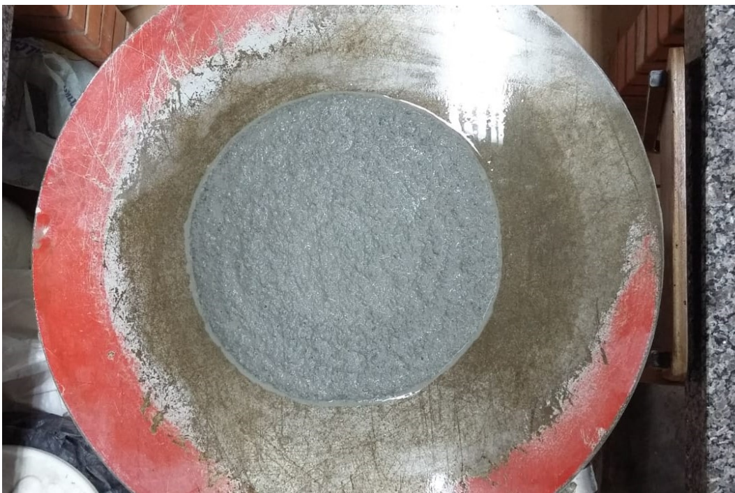
Figura 5: Espalhamento da argamassa na flow table.
