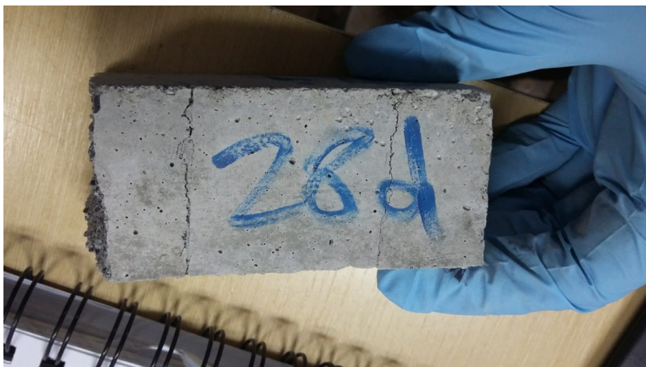
Figura 8: Corpo de prova 4 cm x 4 cm x 8 cm.
