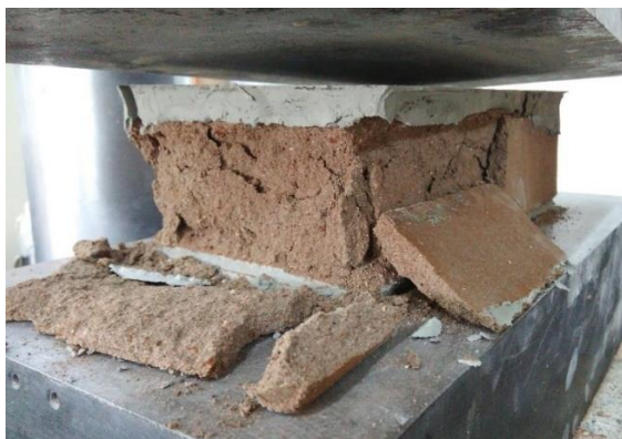
Figura 47 - Bloco com areia sem saturação após o rompimento
