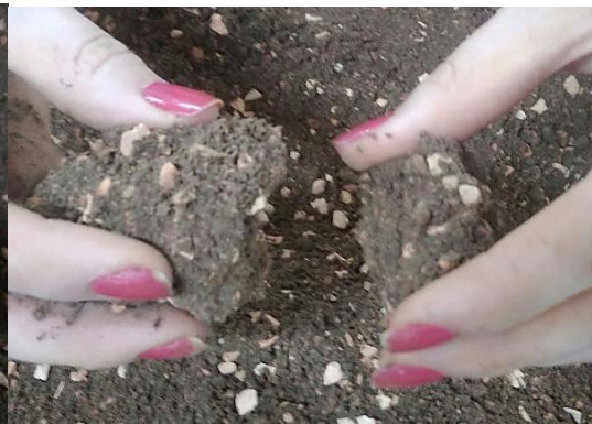
Figura 26 - Bolo partido sem fragmenta-lo de solo-cimento corrigido com cerâmica
