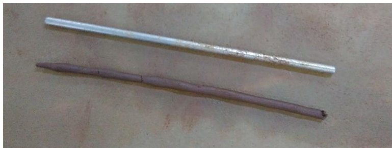
Figura 17 - Ensaio de limite de plasticidade do solo
