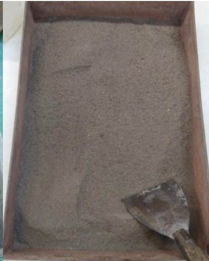
Figura 20 - Mistura de solo-cimento corrigido com areia
