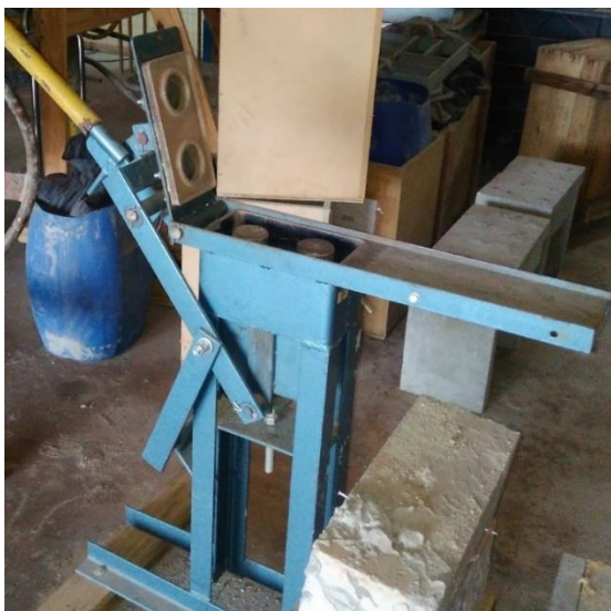
Figura 27 - Prensa utilizada na moldagem dos blocos
