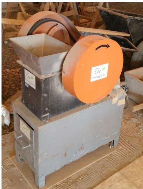
Figura 11 - Britador utilizado na moagem do RCD
