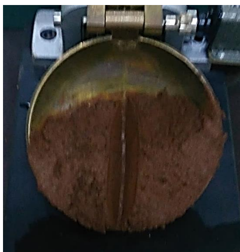
Figura 15 - Ensaio de limite de liquidez do solo com areia natural
