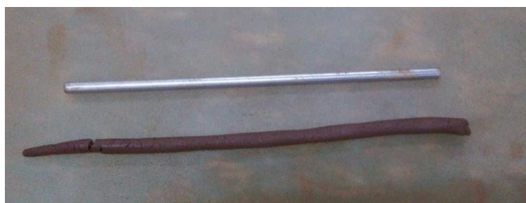
Figura 18 - Ensaio de limite de plasticidade do solo com areia natural
