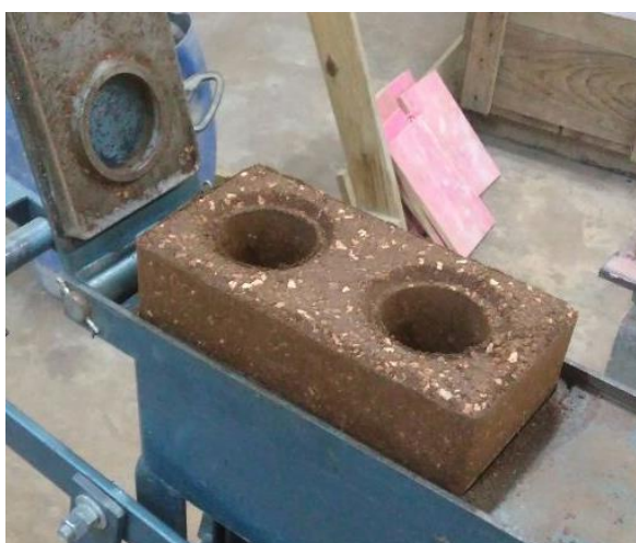
Figura 32 - Bloco solo-cimento corrigido com RCD
