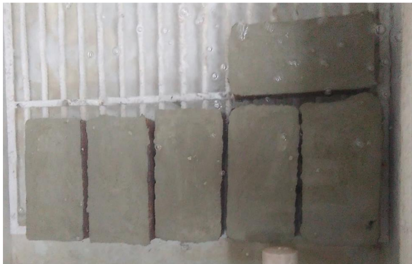
Figura 38 - Blocos submersos antes do ensaio de resistência à compressão
