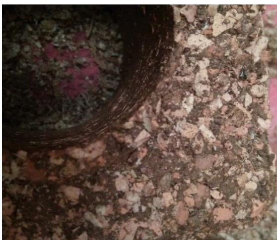
Figura 54 - Detalhe dos grãos do bloco com RCD
