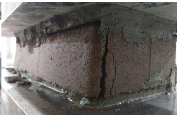
Figura 48 - Ruptura do bloco com areia saturado
