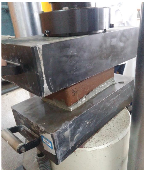
Figura 39 - Bloco submetido ao ensaio de resistência
