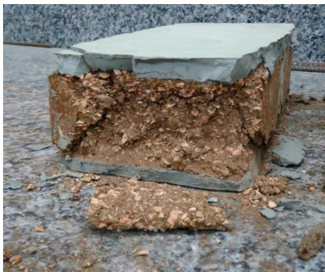
Figura 49 - Bloco com RCD sem saturação após o rompimento
