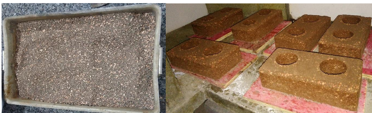
Figura 42 - Mistura de solo-cimento com a correção do RCD pelo volume de areia natural Fonte: Acervo pessoal (2018).
