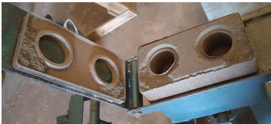
Figura 29 - Material descolado do bloco causado pelo teor de umidade inadequado
