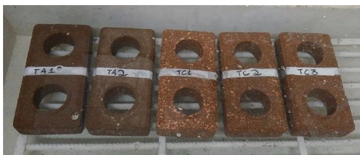
Figura 41 - Blocos submersos em água para determinação da absorção
