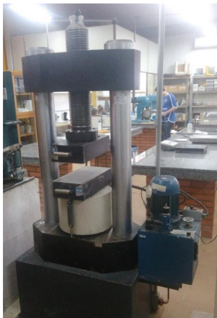
Figura 36 - Prensa utilizada na determinação da resistência à compressão
