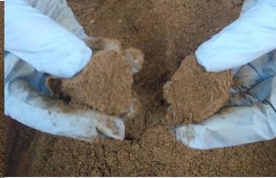
Figura 24 - Bolo partido sem fragmenta-lo de solo-cimento corrigido com areia
