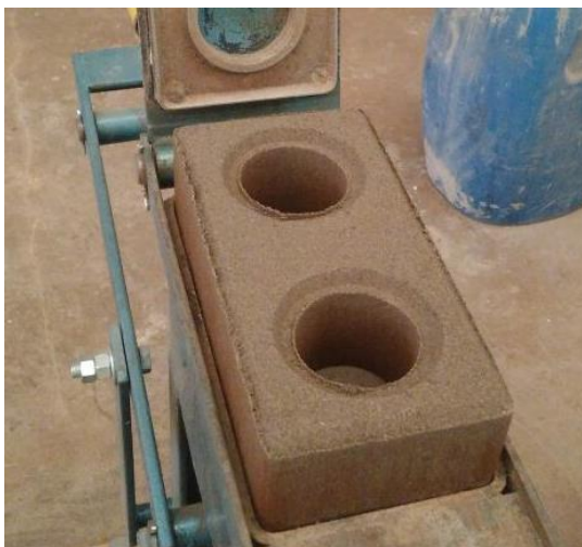
Figura 31 - Bloco solo-cimento corrigido com areia moldado
