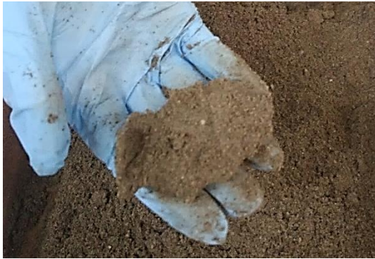
Figura 23 - Teste da mão com a solo-cimento corrigido com areia
