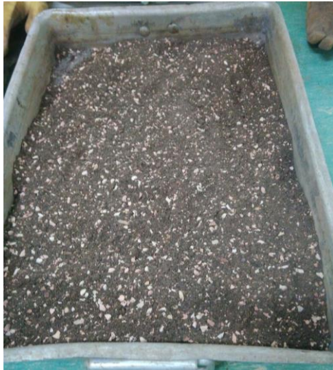
Figura 19 - Mistura de solo-cimento corrigido com RCD
