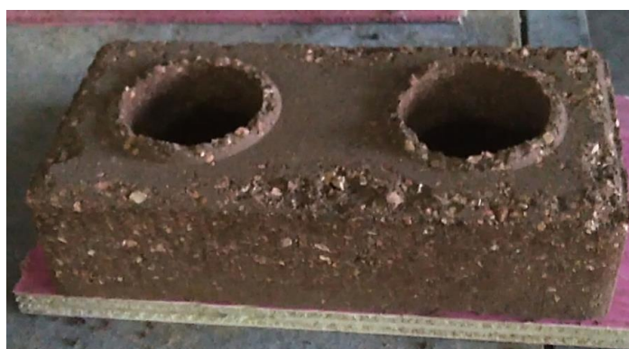
Figura 55 – Aparência dos blocos fabricados com RCD
