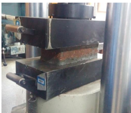
Figura 45 - Ensaio de resistência à compressão do bloco com a correção de RCD em volume Fonte: Acervo pessoal (2018).
