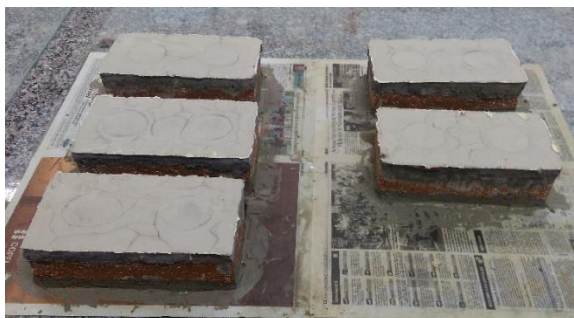
Figura 44 - Capeamento dos blocos feitos com a correção do RCD em volume de areia Fonte: Acervo pessoal (2018).
