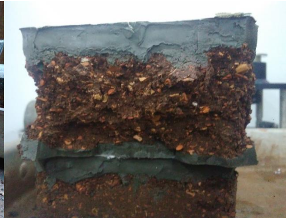
Figura 52 – Bloco corrigido com RCD corrigido em volume saturado após o rompimento
