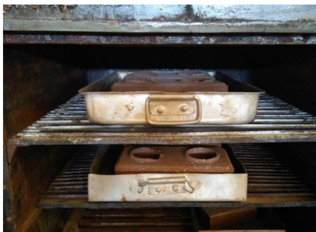
Figura 40 - Blocos secando em estufa para o ensaio de absorção
