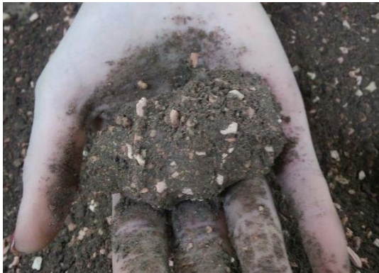
Figura 25 - Teste da mão com a solo-cimento corrigido com cerâmica
