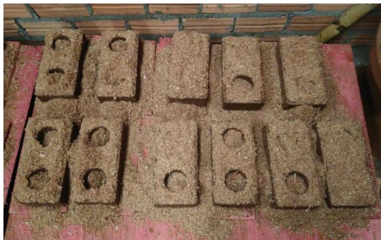
Figura 35 - Blocos com serragem umedecida para favorecer a cura
