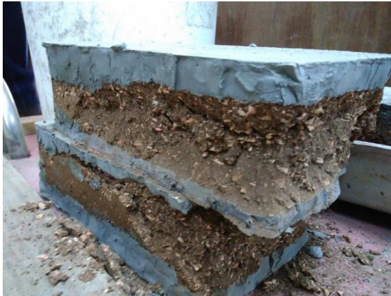
Figura 51 - Blocos corrigidos com RCD corrigido em volume sem saturação após o rompimento
