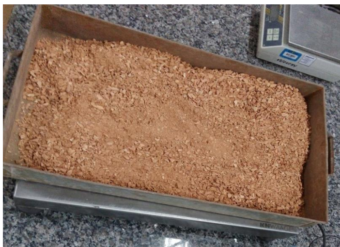
Figura 12 – Resíduos cerâmicos moídos e peneirados
