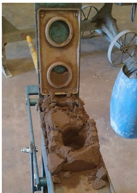
Figura 28 - Bloco de solo-cimento pouco coeso
