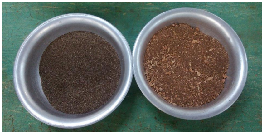
Figura 14 - Amostras de solo corrigido com areia natural e solo corrigido com RCD
