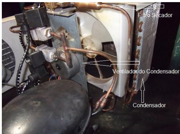
Figura 24: Arranjo do Filtro Secador, ventilador do Condensador.
