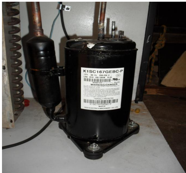
Figura 13: Compressor rotativo fixado na bancada.
