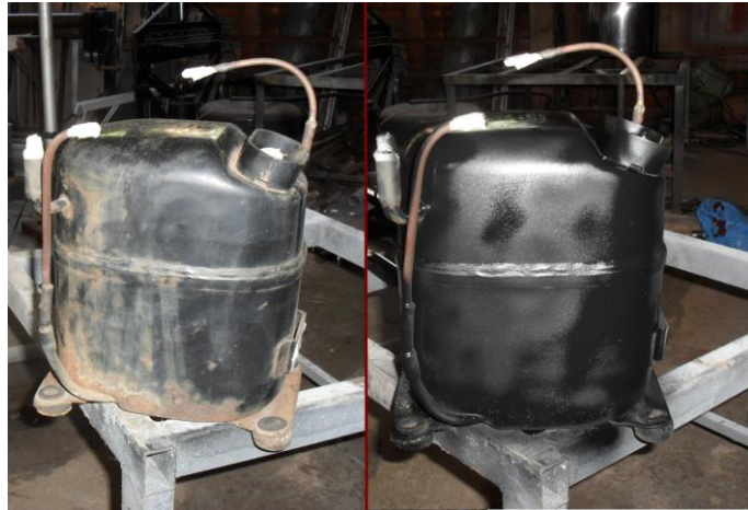
Figura 12: Antes e depois de reforma no compressor alternativo.
