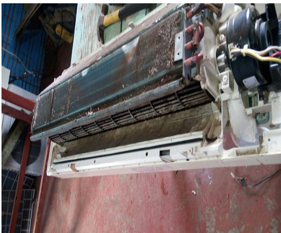
Figura 7: Separação da parte eletrônica Fonte: Zimmermann Rafael e Quevedo Fabio
