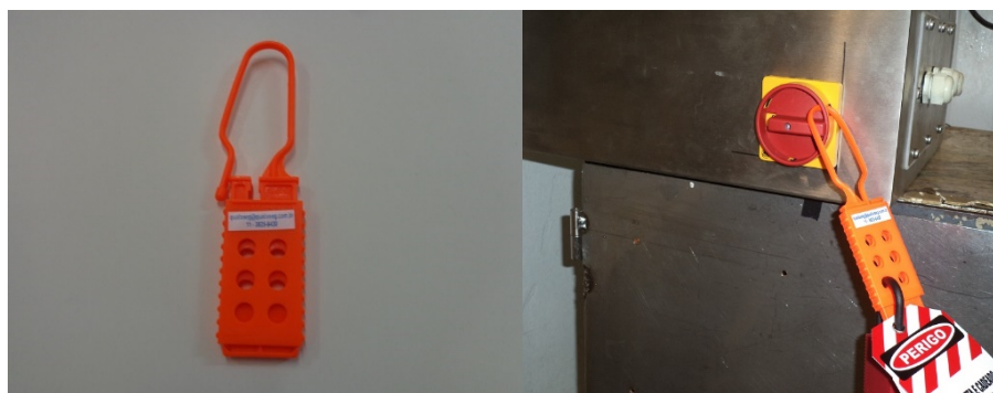
Figura 8: Bloqueio de garra para vários colaboradores
