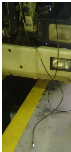
Figura 3. Remoção do cabo de velocímetro.
