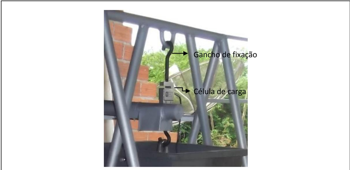
**Figura 9 - Gancho de fixação da célula de carga.**
