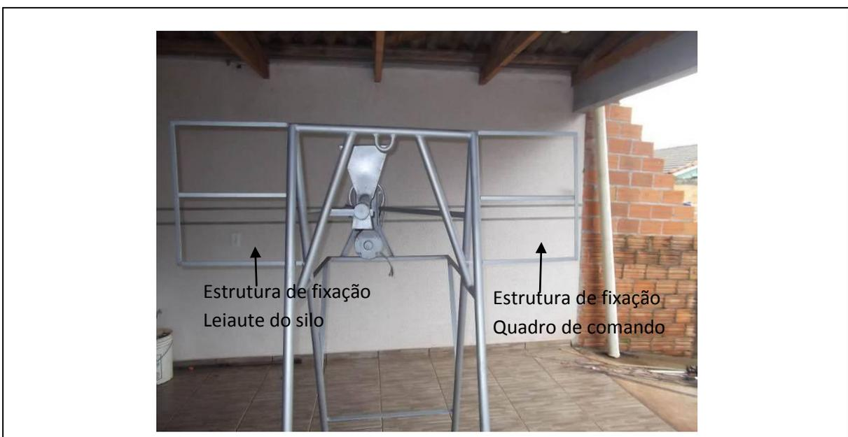
**Figura 14 - Estrutura de fixação do quadro elétrico e do leiaute do silo.**
