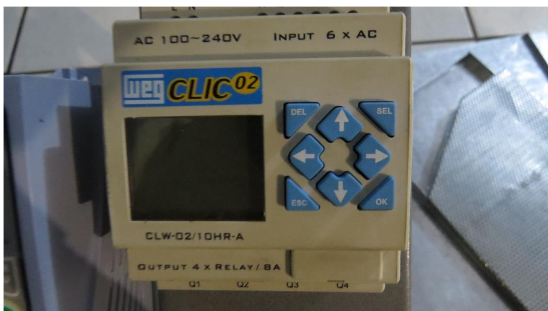
Figura 09 - Controlador Lógico Programável Compacto WEG. Fonte: Autoria própria.
