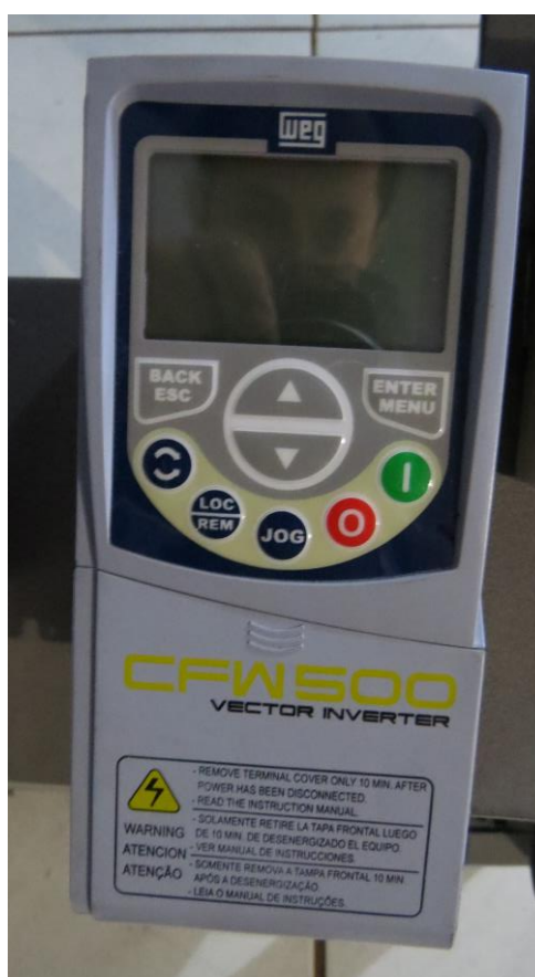
Figura 27 - Inversor CFW500 usado na rebobinadeira. Fonte: Autoria própria
