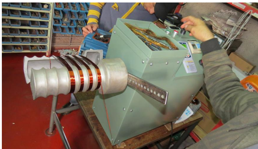
Figura 40 - Motor sendo feito no molde imbricado. Fonte: Autoria própria
