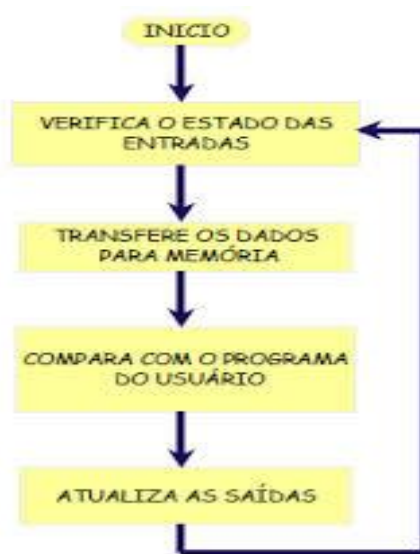
Figura 08 - Ciclo de varredura de um CLP. Fonte: Apostila controladores lógicos programáveis
