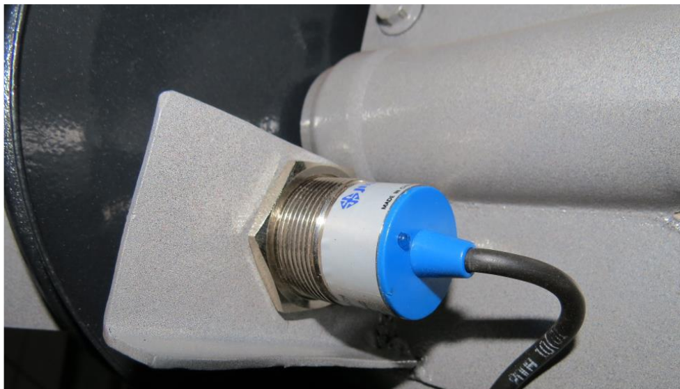
Figura 18 - Sensor indutivo. Fonte: Autoria própria.
